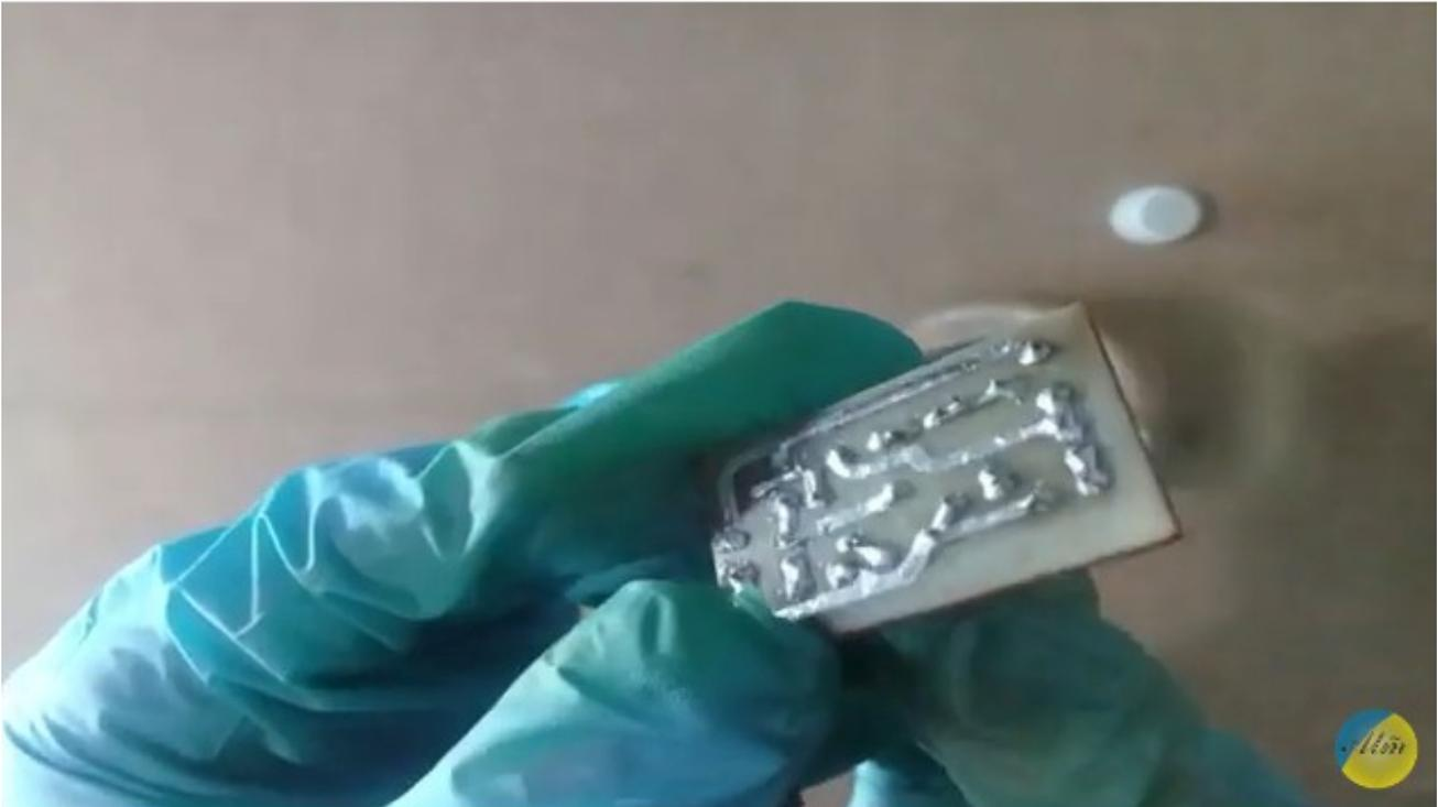
Al terminar con tiner y un cepillo, eliminamos los restos de pasta para soldar o flux
