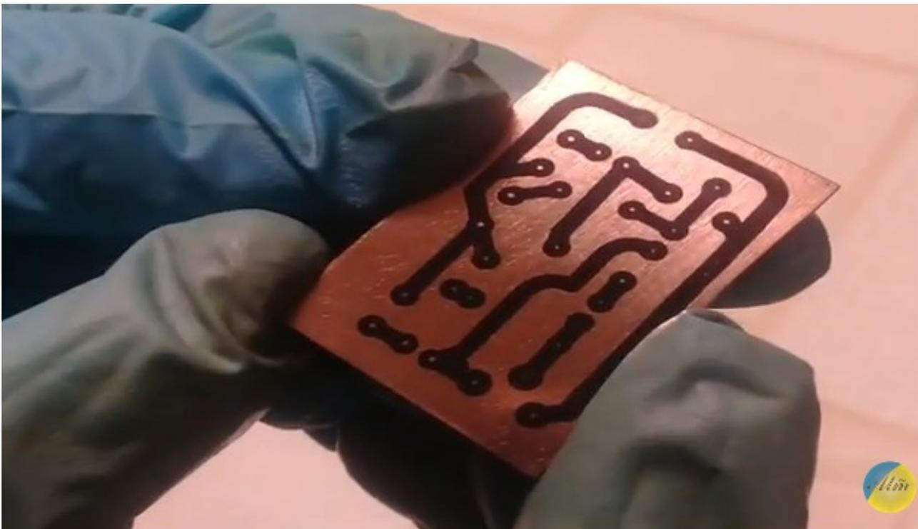
Luego de observar adherido el tóner colocamos la placa dentro de un pote donde se coloca una solución caliente de agua y cloruro férrico donde lo sumergimos la cual agitamos poco a poco.
