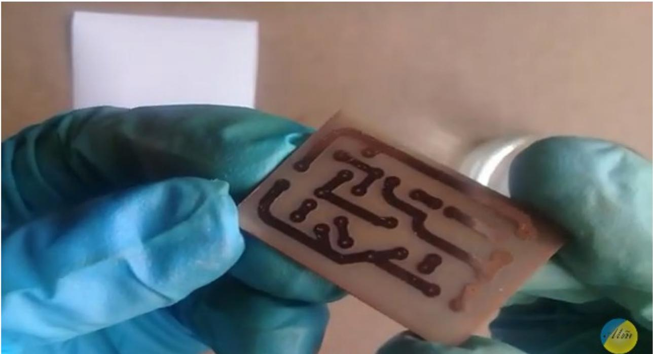
Posteriormente con un motortool y su broca adecuada se le realizan las perforaciones para ubicar los componentes.
