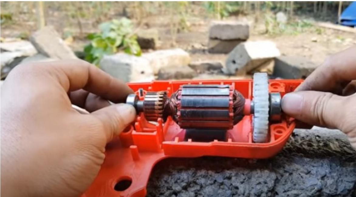
Colocaremos el rotor y comprobaremos que gire, sin ningún tipo de rozamiento
