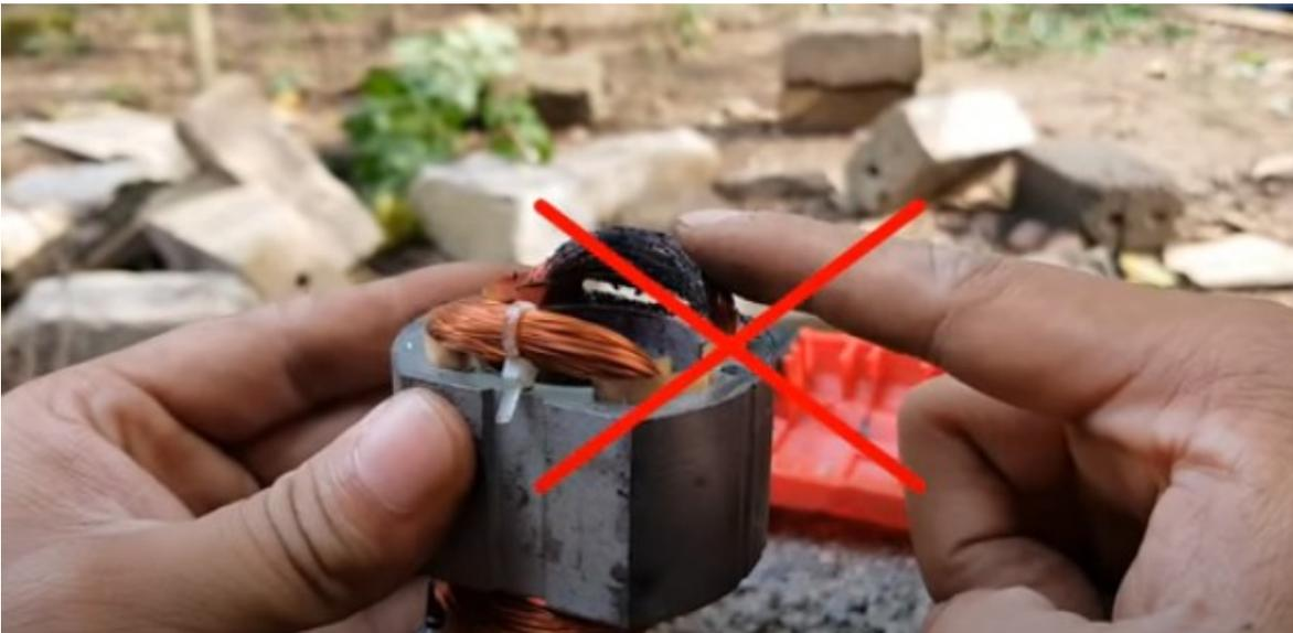
Extraeremos la carcasa del motor y observamos que tiene una bobina quemada, a esto se debía que ya no estaba funcionando el taladro, la vamos a desechar
