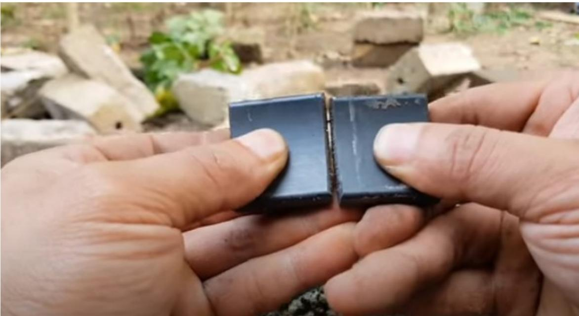
Las bobinas las remplazaremos con dos imanes cortados de la manera que se encuentran en la figura, esto producirá el campo electromagnético necesario para que el rotor genere el torque necesario
