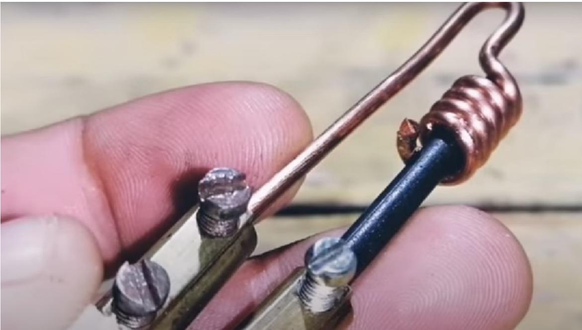
Del otro extremo colocamos nuestra punta de carbono con la punta de cobre que hemos formado, esto se ha hecho con la finalidad que en la punta se concentre la mayor corriente posible
