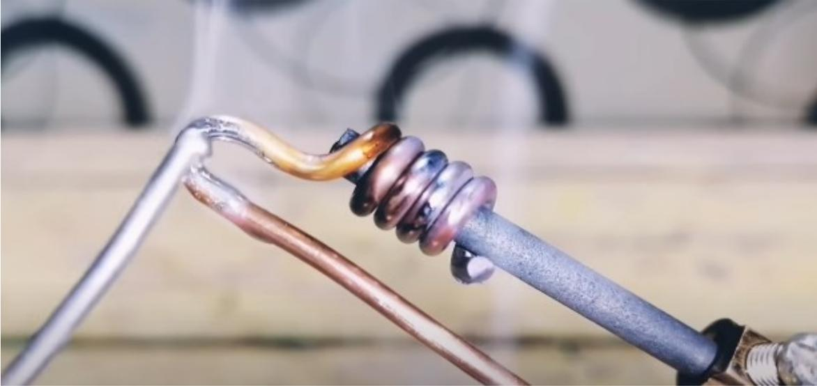
La barra de carbón transmitirá la temperatura y la corriente necesaria para derretir el estaño, adelante con este pequeño proyecto, es todo hasta el próximo
