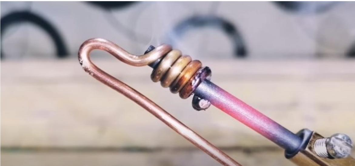
La Entrada del transformador la conectaremos a la red y encenderemos , esto se genera porque el devanado del secundario se cortocircuita , en este caso tenemos 12 V y 1 Am relativamente un voltaje bajo y una corriente relativamente alta la barra de carbón ayuda a que la temperatura se eleve considerablemente
