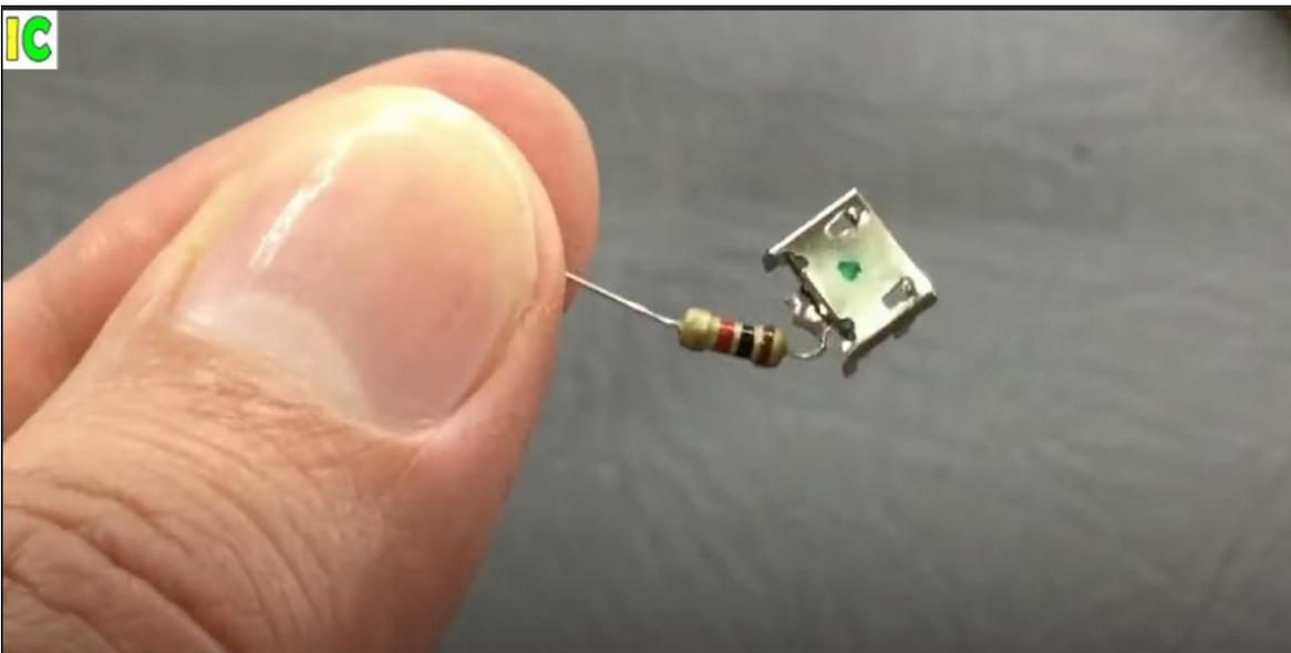
Unir los cables del cargador a la resistencia (el negativo) y a los diodos Led (el positivo) en el pin que se dejó más largo.
