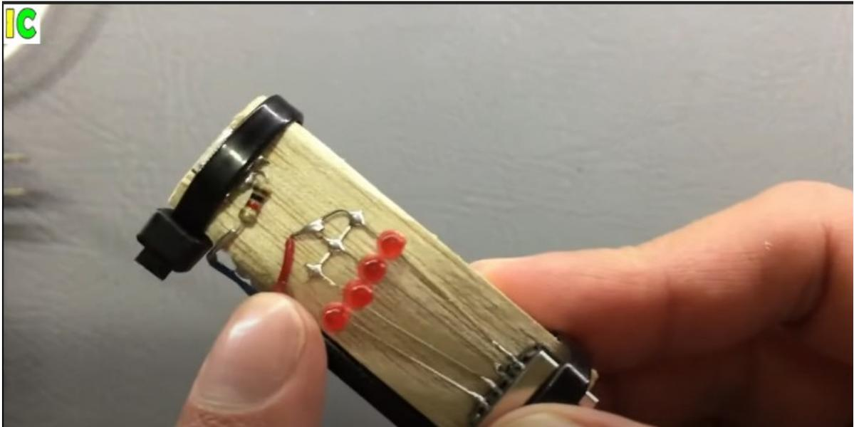
La parte negativa de los diodos Led va cada uno hacia la parte de los pines del USB grande.
