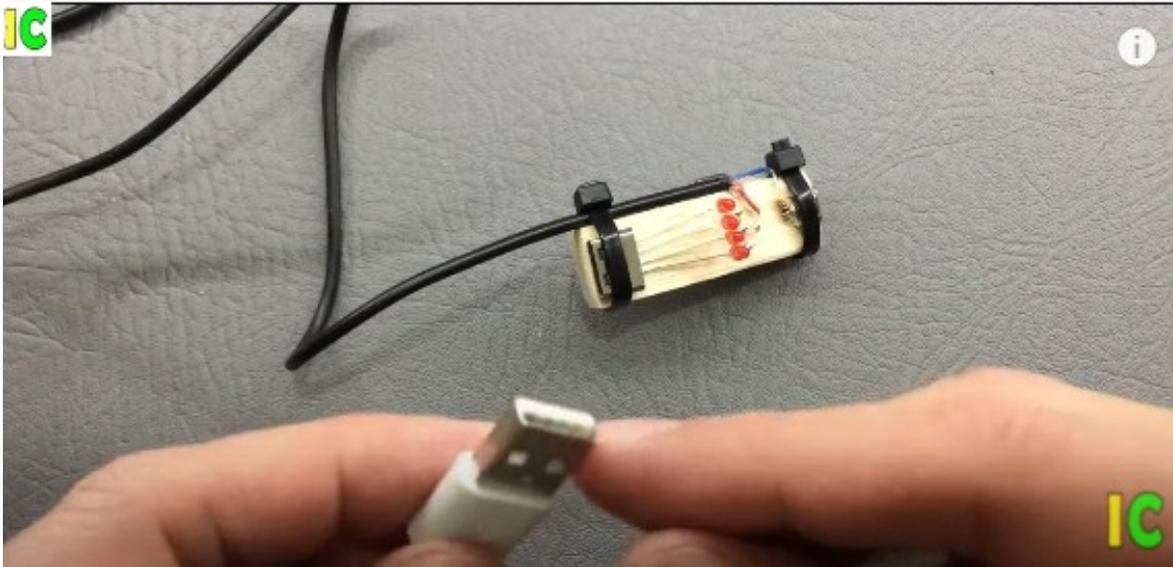
¿Este tipo de cable qué es lo que hace si se conecta a cada uno de los puertos?, solo encienden los dos diodos Led de los extremo, ¿Por qué?, porque este cable es solo para alimentar, este cable básicamente se utiliza para alimentar los disco duros que tienen conector micro USB, si se intenta usar este cable para comunicarse con algún celular entonces no va a servir, este invento sirve para verificar eso.
