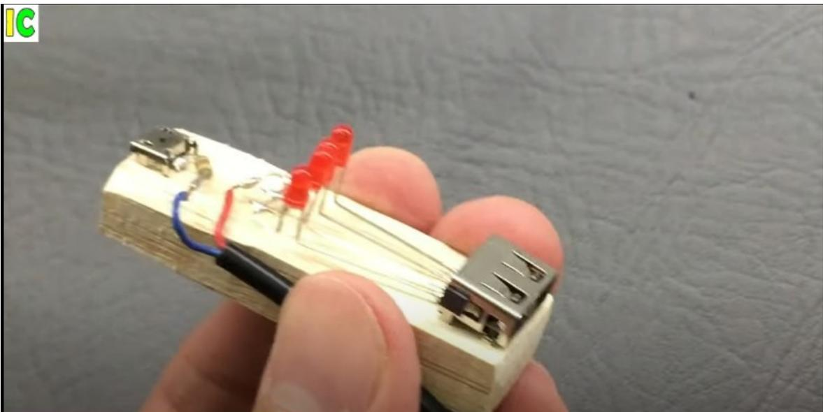
Usar las bridas para asegurar con más firmeza los conectores y el cable a la madera.
