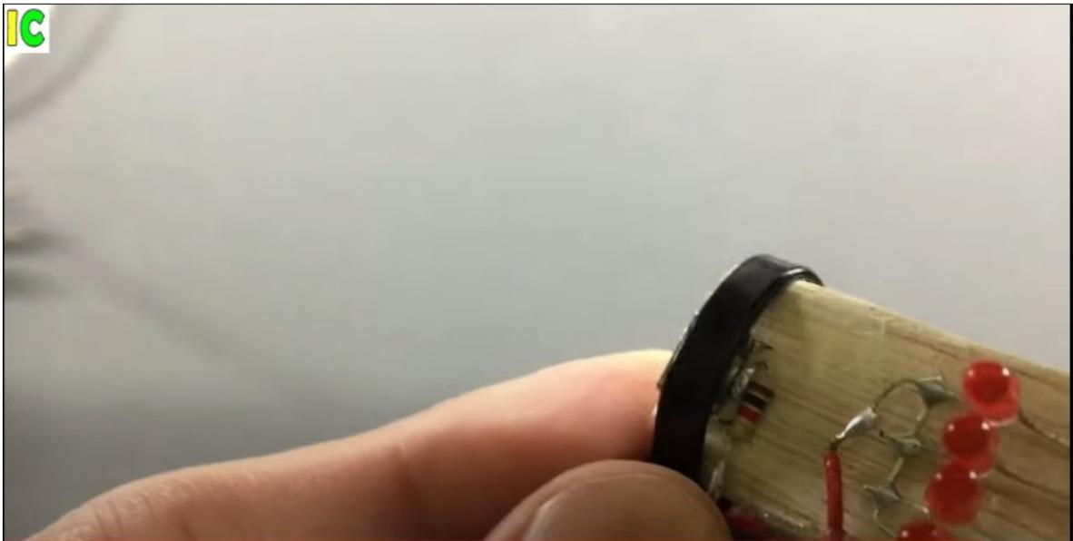
La idea es que los conectores tengan unas patas que se hundan o se introduzcan en la madera, para que cuando se conecten los cables a estos, la fuerza que se ejerce no los mueva ya que estarían enterrados en la madera, y la cinta plástica ayuda a sostener el conector para que no se salga, soportando esa fuerza. Recuerden que este tipo de conector USB y micro USB ejercen bastante fuerza en los conectores y deben estar bien apoyados y bien unidos para evitar que se despeguen o se muevan.
