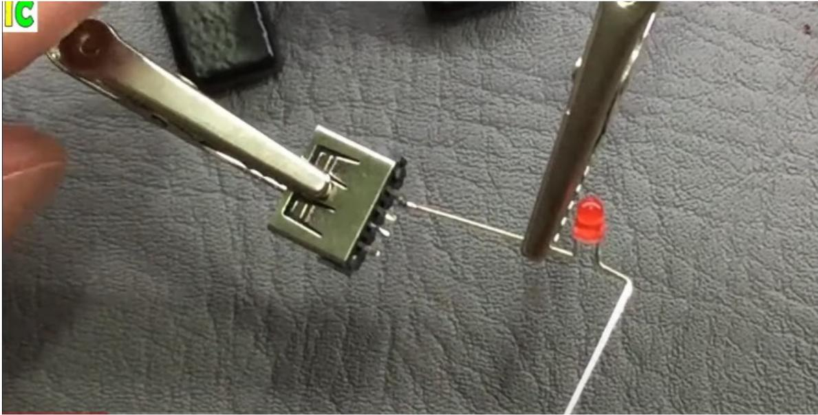
Seguir soldando los otros diodos Led al conector.
