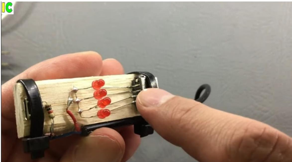
El cable negativo (azul) del alimentador o el adaptador viene con una resistencia de un kilo ohmio y agarra todos los pines de este conector, se unen todos, se le hace un cortocircuito a todos los pines y se suelda con el otro extremo de la resistencia.
