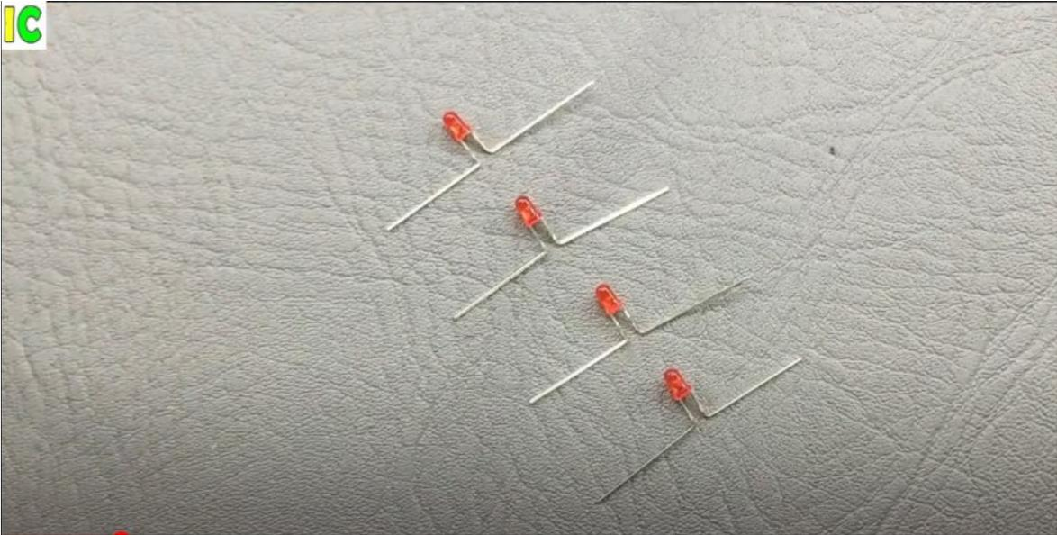
Hacer un tercer dobles a unos de los diodos Led en el pin negativo.
