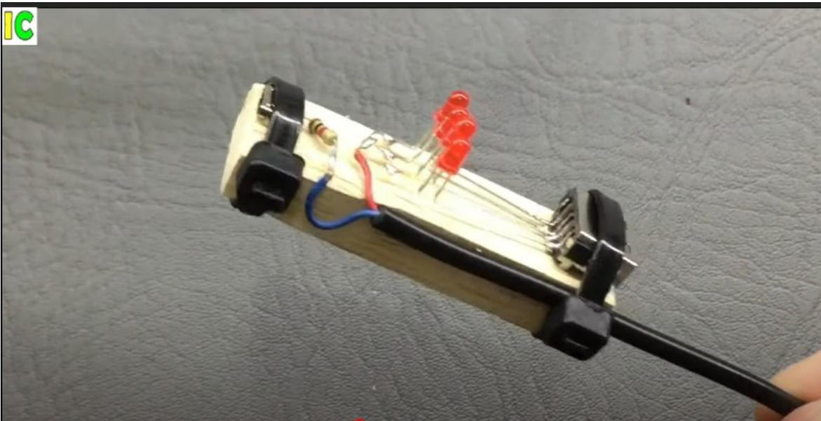
Aplicar silicón a los otros cables que están más descubiertos y fijar a la madera.
