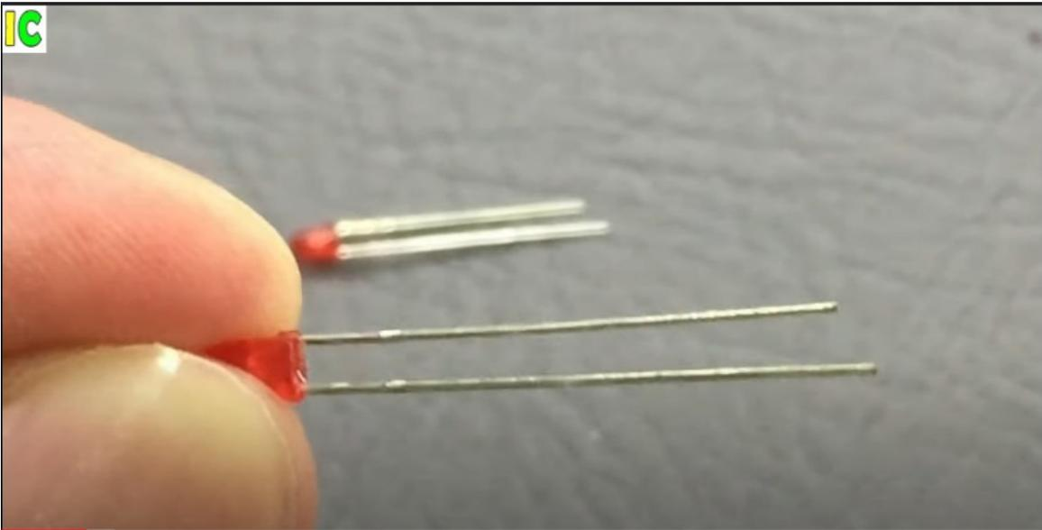
Con ayuda de una pinza se doblan los pin de los diodos Led.
