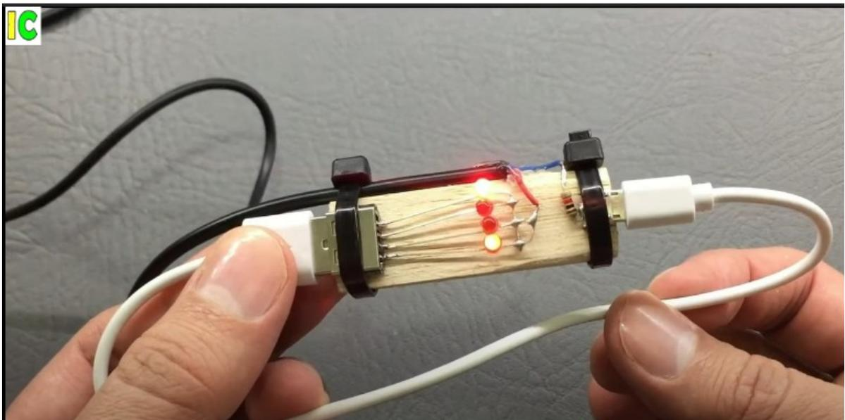
Este cable está un poco viejo pero aún funciona, observen que encienden los cuatro diodos Led; se hará un experimento con este cable que funciona perfectamente, lo que se va a hacer es cortar este cable por la mitad y quitarle una unión para que se vea cómo se verifica con este comprobador de cables.
