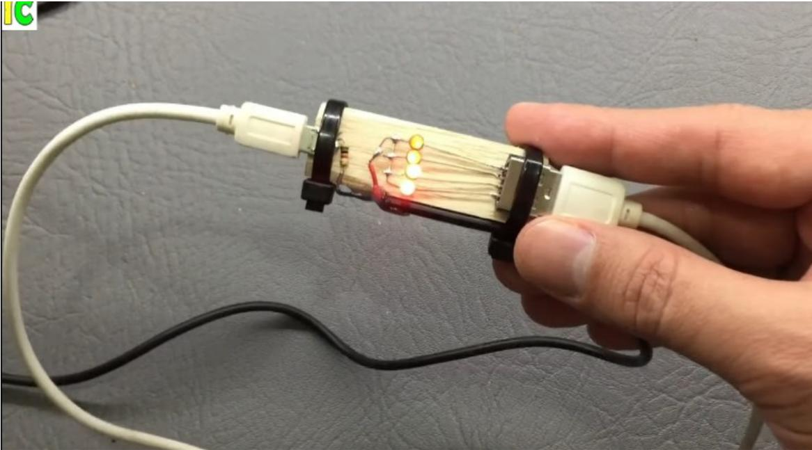
Ya se cortó el cable y se unieron sus cables internos, el cable de color verde con blanco que en algunos casos viene verde solamente, el blanco, el negro y el rojo se dejó desconectado para simular una falla, para hacer ver que este cable rojo estuviese cortado o fallando.
