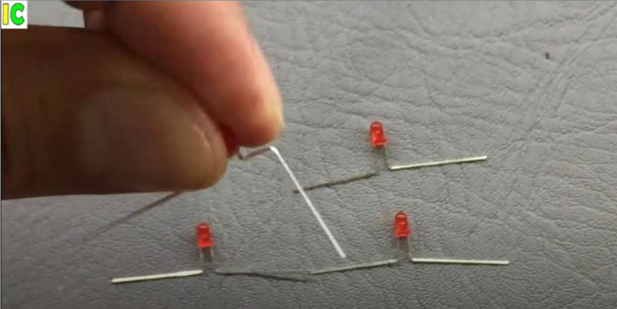
Soldar este último diodo led por el pin positivo al conector grande.
