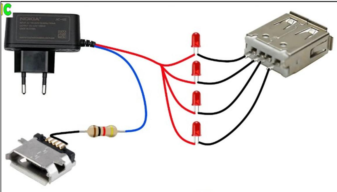
Los diodos Led tienen una parte positiva y una parte negativa, el pin más corto es la parte negativa y el pin más largo es la parte positiva, eso deben saberlo para identificarlo correctamente en el esquema.
