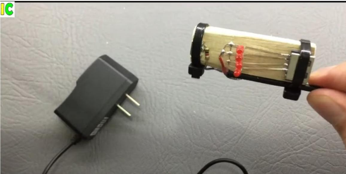
El cable rojo es el positivo que se conecta con los diodos Led y el azul el negativo que se conecta con la resistencia, esto es todo.
