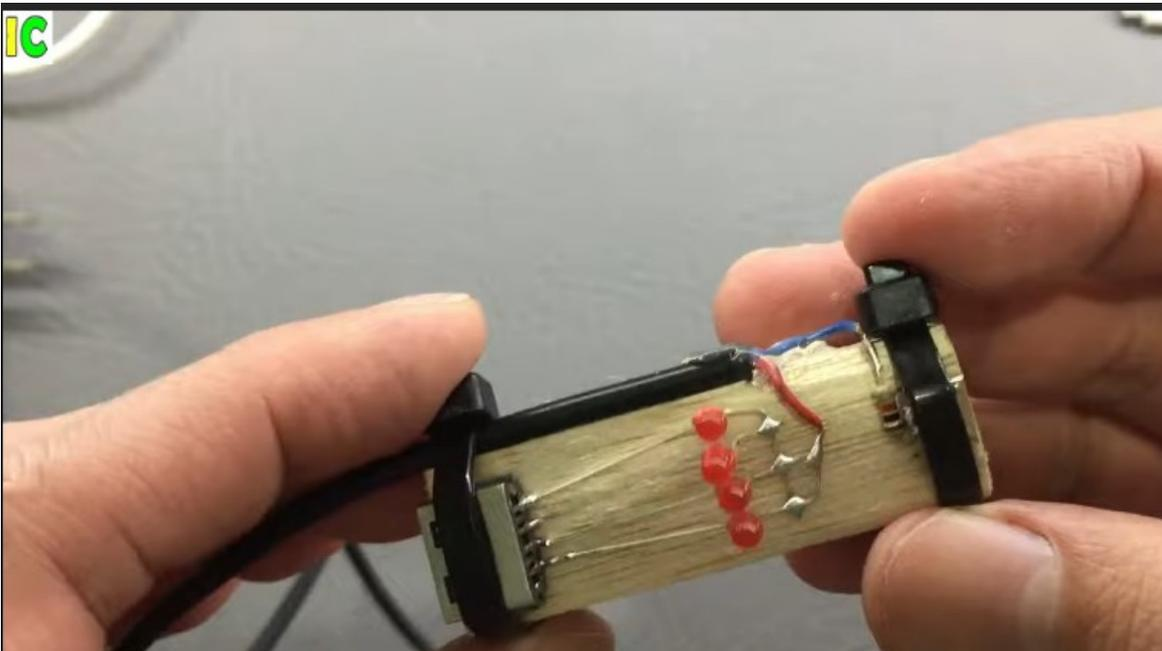
Si se están preguntando si se puede utilizar una batería de 9 voltios o un adaptador de 12 voltios, ¿Qué cambios debería hacer?, pues simplemente pueden dejar la misma resistencia. La resistencia de un kilo puede lograr que estos Led funcionen bien hasta 12 voltios, de todas formas si le ponen una de 4,7 kilos para 12 voltios, Pues también le va a funcionar, se va a iluminar casi igual como se ilumina con 5 voltios como la que se está usando
