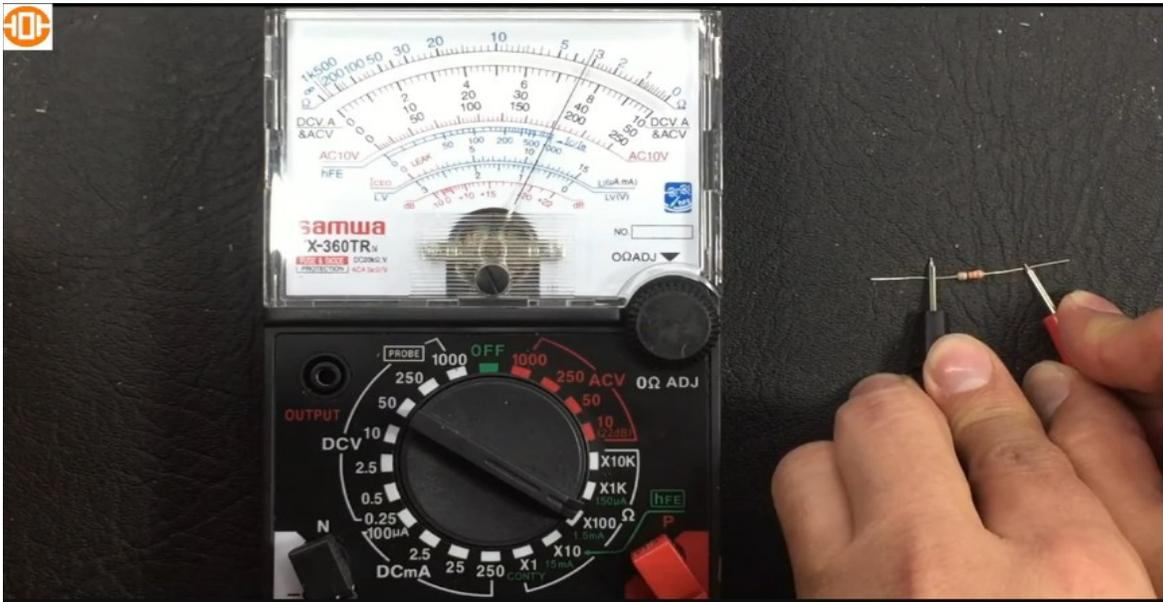
Lo único que falta medir en este multímetro es la escala de corriente continua (DCmA), este multímetro no tiene para medir corriente alterna.
