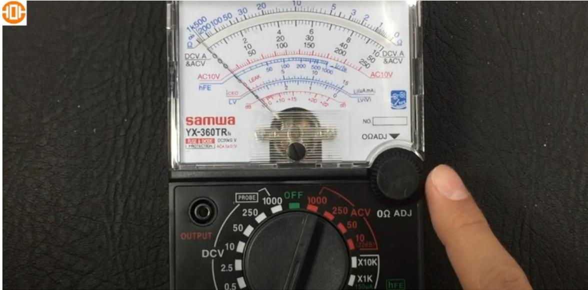
Se conectan los cables, el positivo en el positivo y el negativo en el negativo, se selecciona en la parte de ohmio con las puntas unidas colocamos X100.
