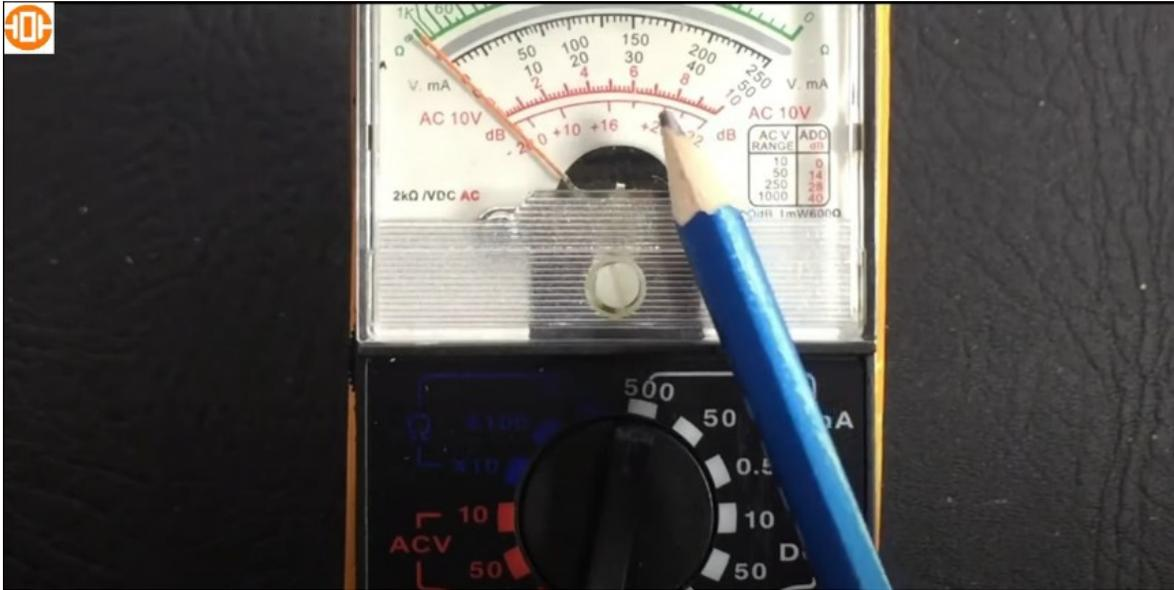
Para trabajar 250 en voltaje continuo (DCV) y voltaje alterno (ACV), fíjense que hay un solo 250 de fondo escala y con este se trabaja para ambos.
