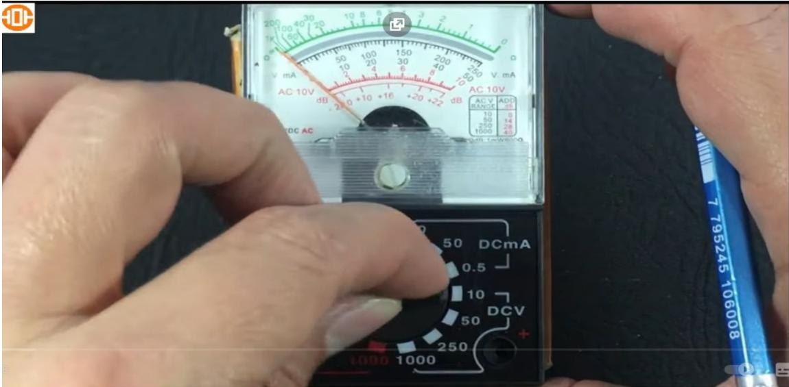
Por ejemplo, es multímetro si tiene una parte donde descansa y hay que colocarlo en OFF, para que no quede encendido gastando energía, sobre todo en la parte de ohmios que podría pasar.
