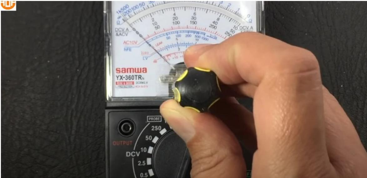
El multímetro analógico se debe leer desde arriba del multímetro, perpendicular a la pantalla, obviamente la lectura es aproximada porque es según lo que se observe.
