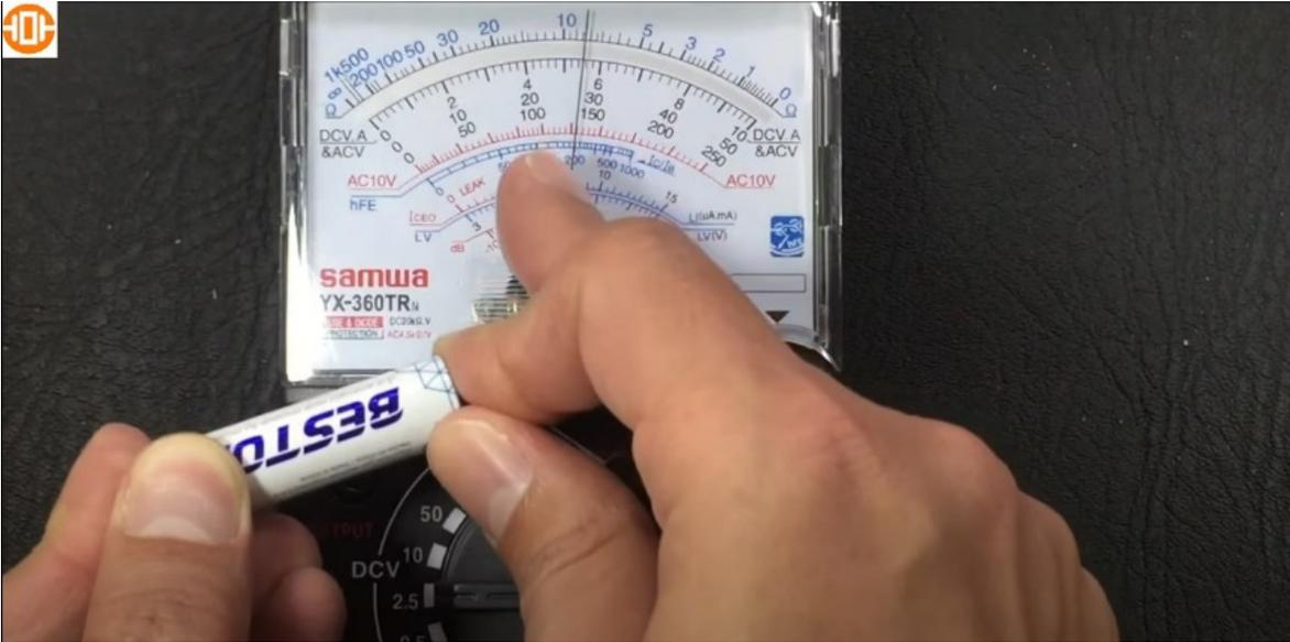
Con el multímetro digital mide 1,42; o sea que el multímetro analógico está dando el valor de manera correcta.
