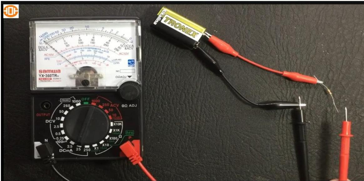
Si se coloca en el rango de 25 se pasa, toca colocarlo en 250 y trabajar con el 250 del fondo de escala.
