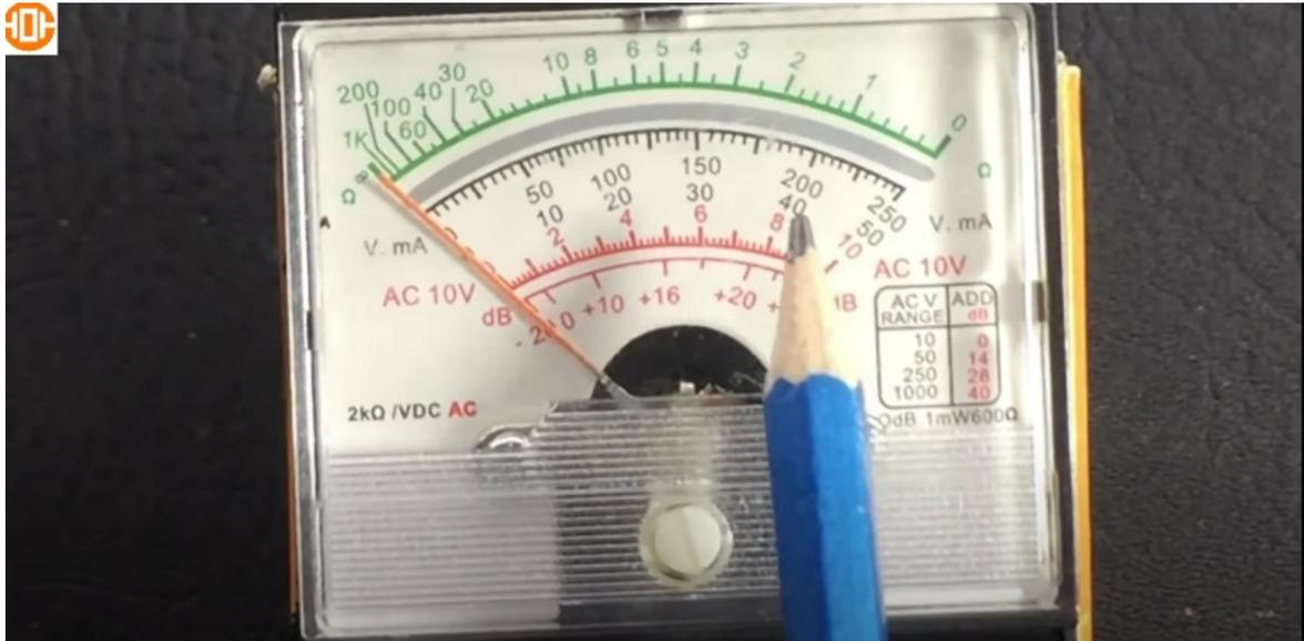
Si se va a trabajar con la de 10 esa se tiene ahí, pero fíjense que en el multímetro hay un valor de 1000, si ese valor no aparece en ninguna franja, en un fondo escala que diga 1000, entonces se trabaja con el mismo 10, que se utilizara como un submúltiplo, simplemente donde va el 10 asumimos que es 1000.
