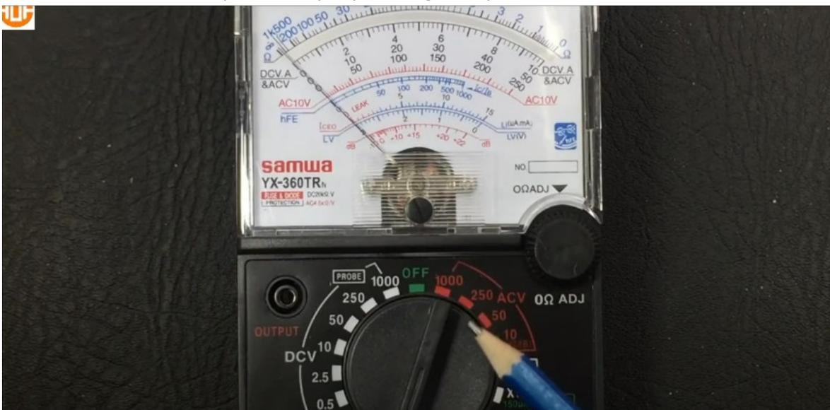
Al igual que el otro multímetro aquí está el ajuste para el ohmio, este no afecta para nada el OC, es solo para la parte de ohmio que arriba en azul.
