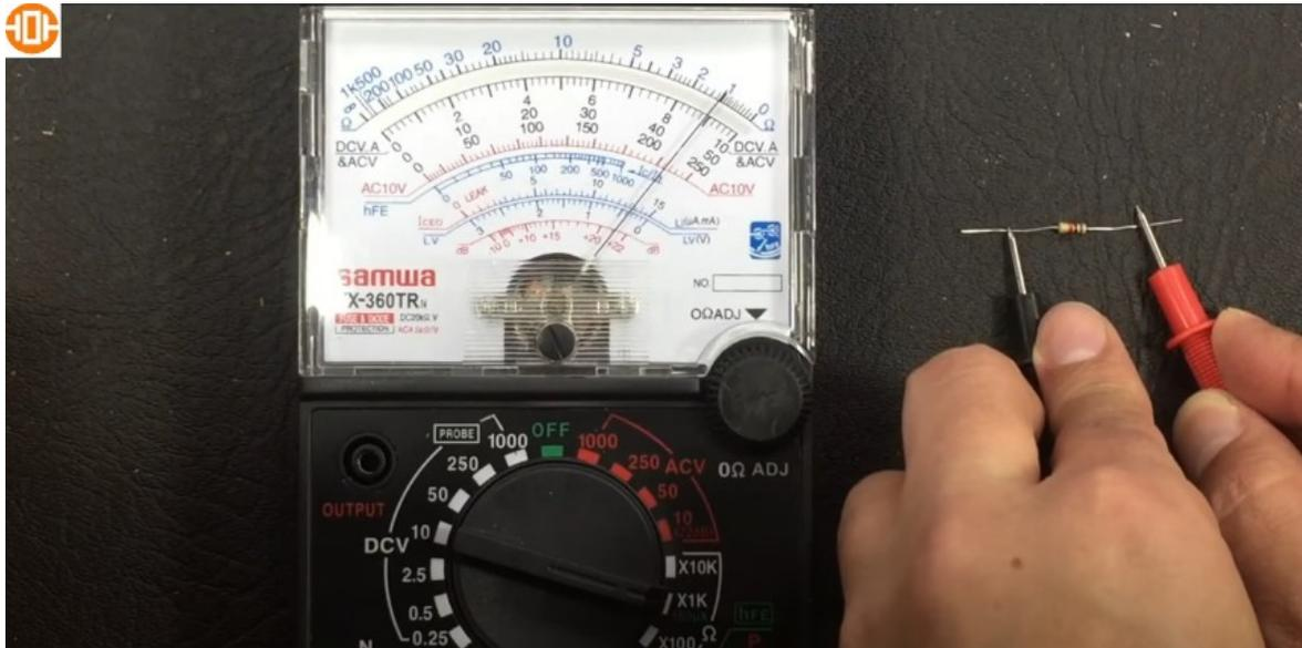
Si se coloca por X10K se va a un valor que es muy impreciso, aquí en teoría debería ser 0,1 por 10000 para que de 1000, pero quizás se puede pensar que es 0,2 y se dirá que es 2 kilos o 1.5 kilos, o sea en este rango no se debe hacer, lo ideal sería X1K o X100, la mejor precisión se tiene en X100
