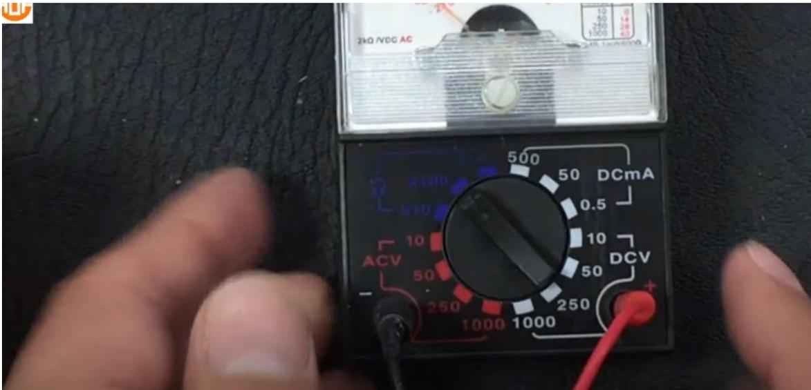
Se coloca en la escala de 10 ohmios y cuando se juntan las dos puntas se va hasta el final, pero no llega a "0".
