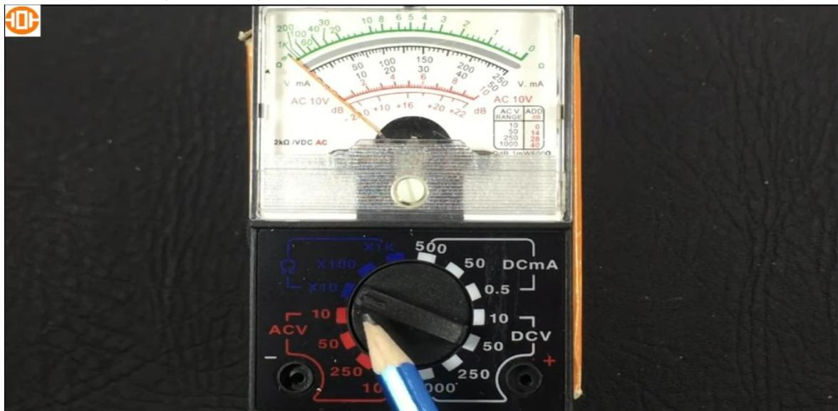
Si quisieren escoger otra escala tendrían que girarlo hacia la escala y el rango que se requiera. Este no tiene un botón de OFF ni una parte de OFF, pero no sucede en todos los casos.
