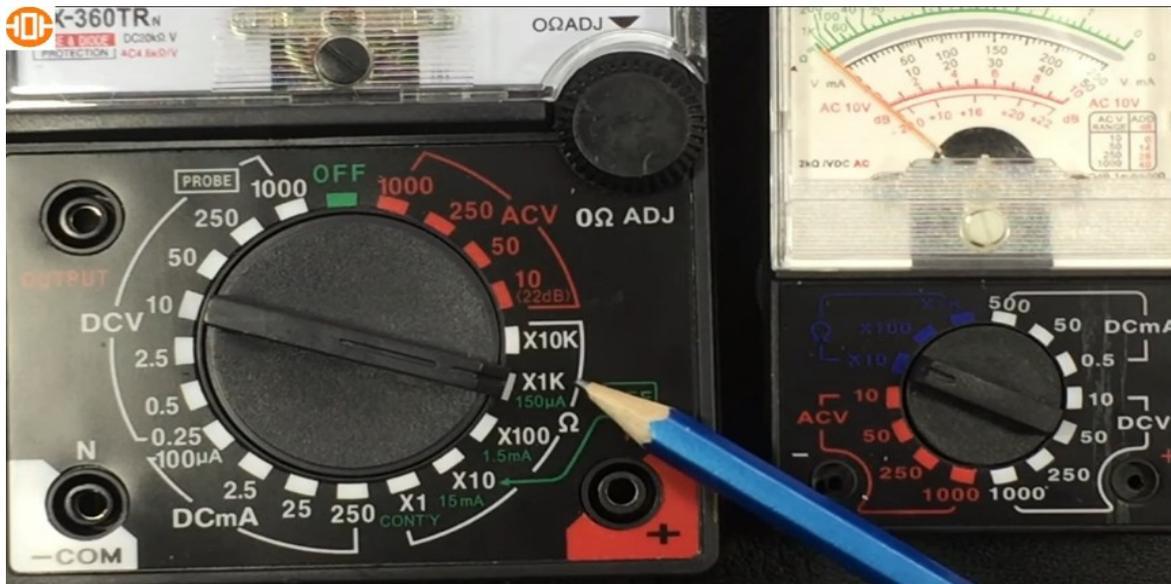
Si se revisa el multímetro más pequeño, el rango de mil amperios de corriente directa (DCmA), tiene 500 mil amp, 50 mil amp, 0,5 mil amp, hasta aquí llega en este multímetro.
