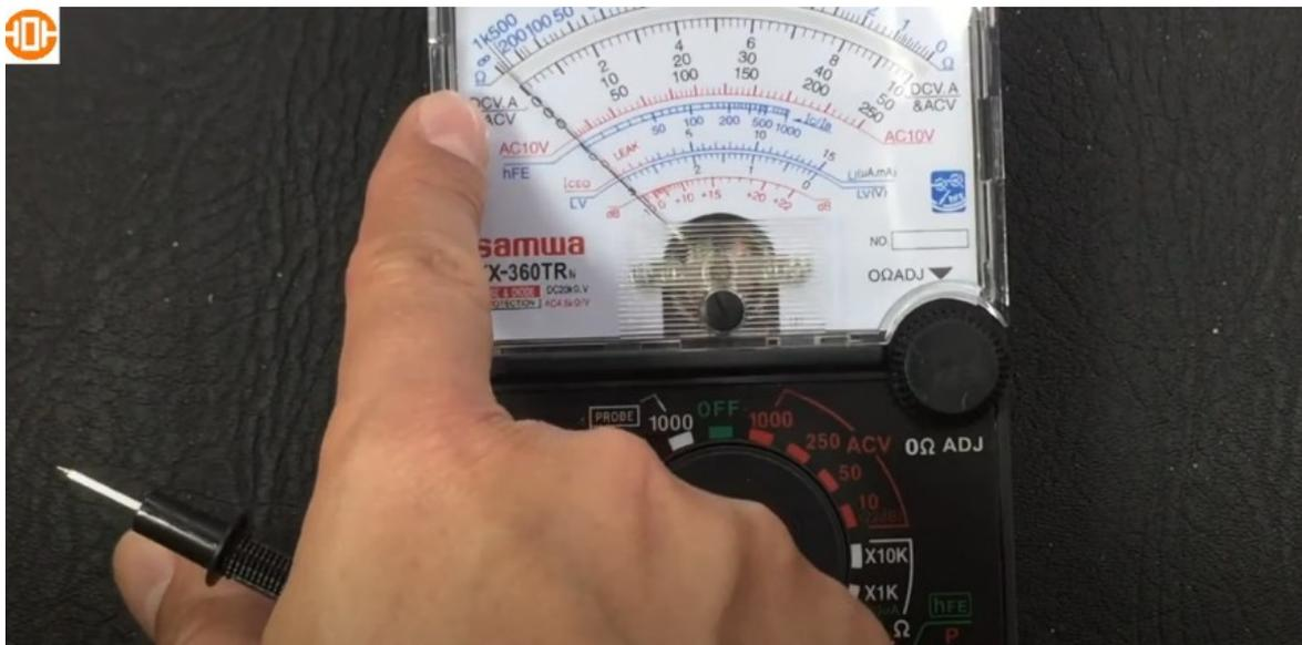
Una cosa curiosa en estos multímetros es lo siguiente, si se calibra X100 en el caso de la medición de ohmios es porque se va a medir justamente con este multiplicador, sucede que si se va a medir con X1K o X10K quizás el "0" no va a ser el mismo.
