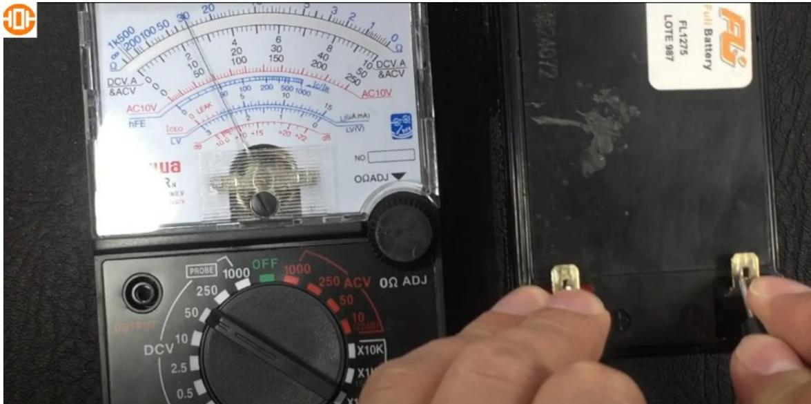
Se puede corroborar, como se está haciendo la comparación para verificar que todo está funcionando correctamente con el multímetro analógico, ahora se hará con el digital. Observen que marca 12,58 o sea que el multímetro analógico está funcionando perfectamente en la escala de voltaje de corriente directa (DCV).
