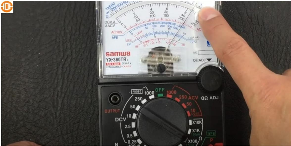
Entonces se hace el ajuste en "0", hay indica que ya esta calibrado para medir ohmios.
