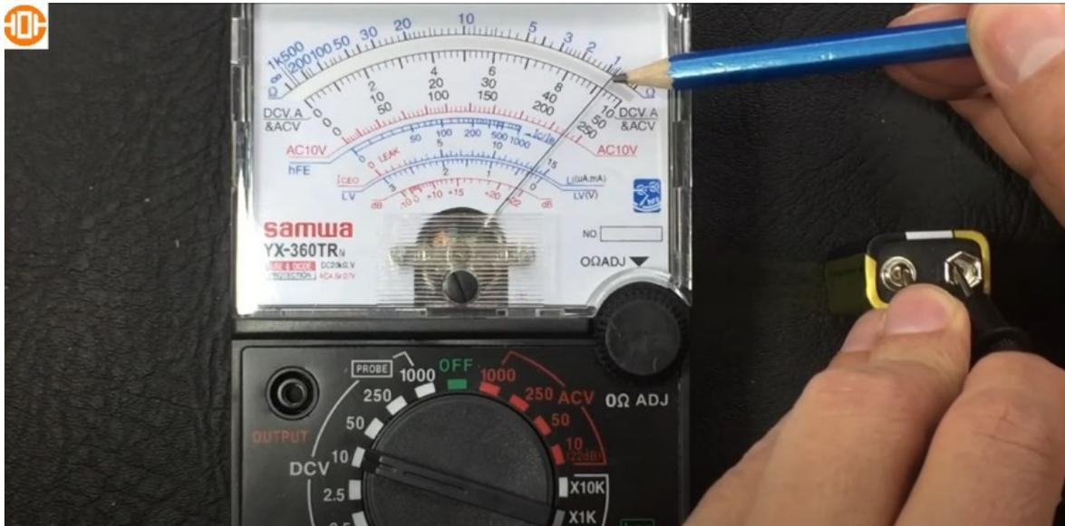
Con el multímetro digital da más de 9,66 que es lo mismo que dice el multímetro analógico, eso pasa porque la pila esta nueva no esta usada. Entonces no hay problema con la medición del multímetro analógico.
