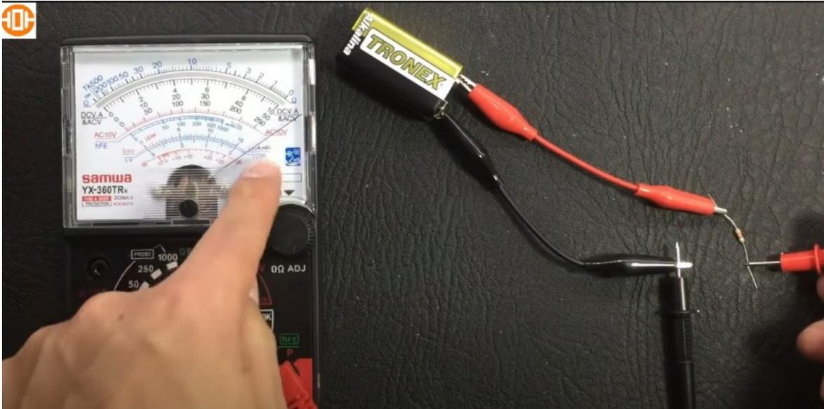
Por último, se harán unas aclaraciones porque este multímetro hay que tenerle un poco de cuidado con esta parte que se va a mostrar. Cuando se hizo la medición de voltaje se ubicó el positivo y el negativo. Si se hace una medición de voltaje en la escala adecuada y en el rango adecuado y no se toma en cuenta el positivo y el negativo dependiendo del valor que se esté midiendo quizás el multímetro podría doblar la aguja si es muy delicada.
