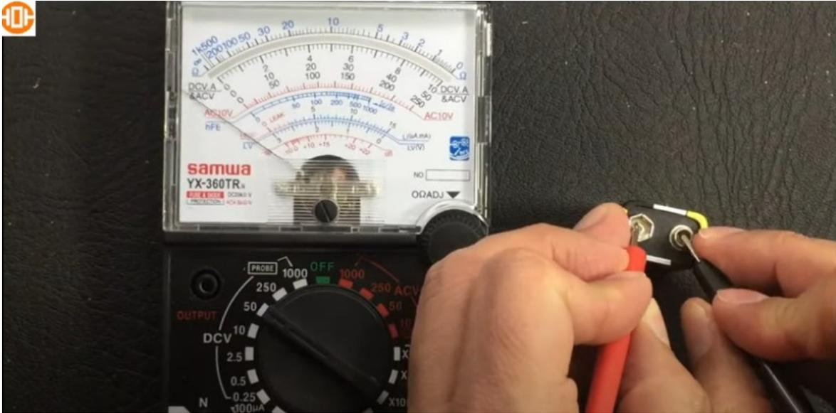
Igual si se escoge un rango muy bajo siendo la batería de 9 voltios y midiendo de forma correcta la aguja se tirará al otro extremo de forma muy rápida y podría dañarse, porque el multímetro no espera que se mida un voltaje de 9 voltios si se está escogiendo uno menor de 2,5. Deben tener mucho cuidado en colocar los rangos adecuados para que no ocurra estos errores y puedan proteger su multímetro analógico.
