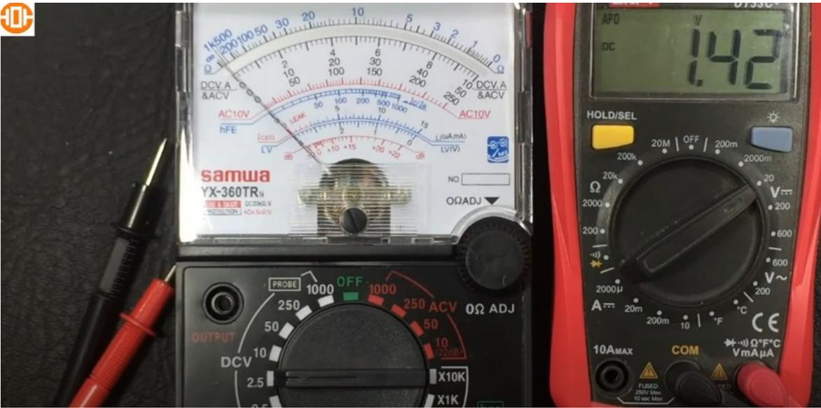
Para otra medición esta es una batería de 12 voltios, al parecer esta cargada pero pasa los 12 voltios, igual se va a medir con el multímetro analógico. El rango a usar no podría ser de 10 ya que es menor de 12 que es el valor de la batería.
