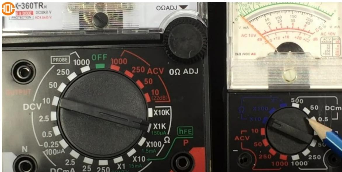
En voltaje de corriente directa DCV va desde 10 voltios, 50 voltios, 250 voltio y 1000 voltios; en corriente alterna ACV se tiene 1000 voltios, 150 voltios, 50 voltios y 10 voltios y en la de ohmios son los multiplicadores de la escala de ohmios, multiplica por 10, por 5 y 1 kilo.
