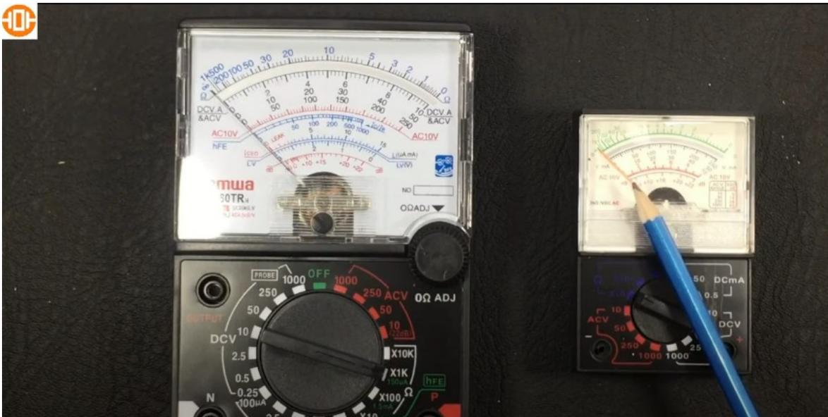
En comparación con el multímetro digital, el digital tiene una pantalla e igual que el analógico, pero este tiene números rotulados o escritos al fondo y una aguja que va a indicar el valor. La parte que se señala con el lápiz se parece bastante a los multímetros analógicos de hecho es casi igual su funcionamiento y su forma de seleccionar los valores.
