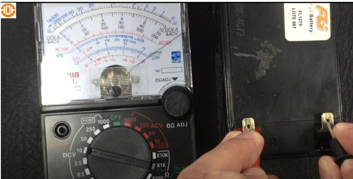
En este caso como el valor es muy cercano, no es muy alto, el multímetro no se dañó, pero no marca bien, marca un valor muy extraño porque se sale del fondo escala. Es algo lógico porque si el fondo escala es el máximo valor que él puede medir, y si el máximo valor que se marco fue 10, entonces debe medir hasta 10, pero si la batería es de 12 el multímetro no entiende, porque le va
