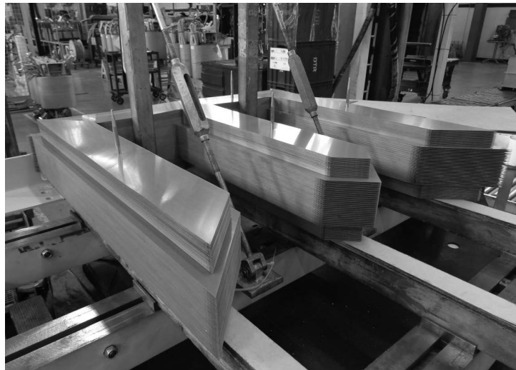
Figura 2.18 Construcción núcleo apilado. (Con autorización de ABB Ltda., Dosquebradas, Colombia)
