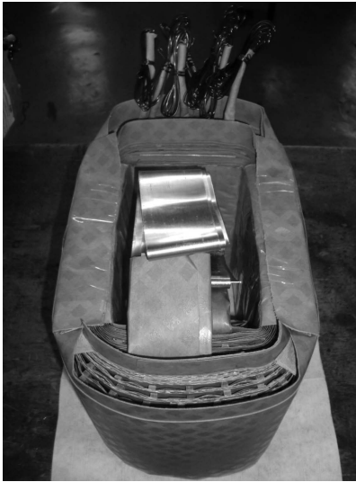
Figura 5.8 Ductos de refrigeración en bobinas (Con autorización de ABB Ltda., Dosquebradas, Colombia)
