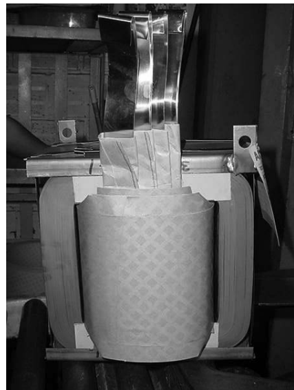
Figura 5.12. Colocación de brida a la parte activa (Con autorización de ABB Ltda., Dosquebradas, Colombia)
