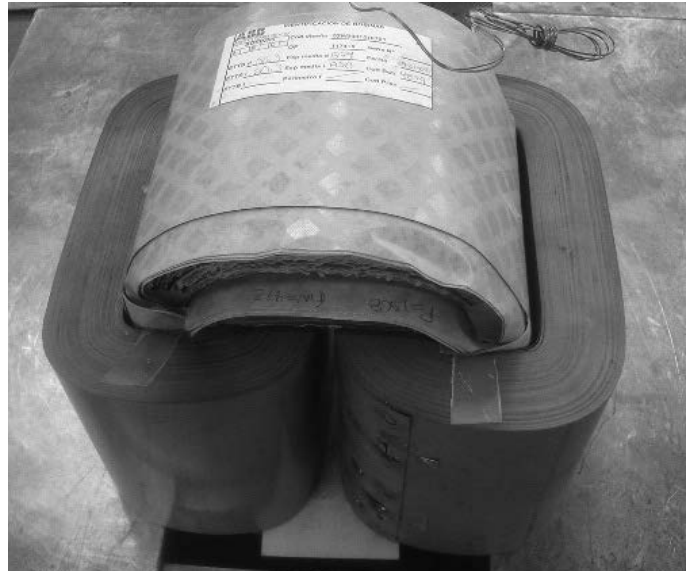
Figura 5.11. Ensamble del núcleo a la bobina (Con autorización de ABB Ltda., Dosquebradas, Colombia)
