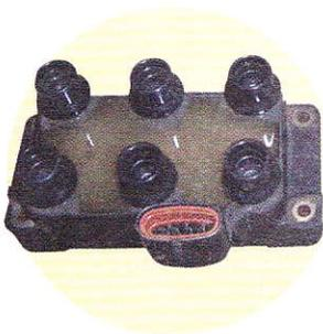
La bobina de seis torretas es en realidad un bloque de tres bobinas, las cuales alimentan a dos bujías a la vez.
