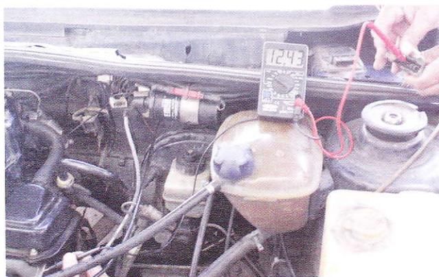
Verificar la tensión en la terminal positiva de la bobina; debe estar cerrado el circuito de alimentación eléctrica del vehículo.
