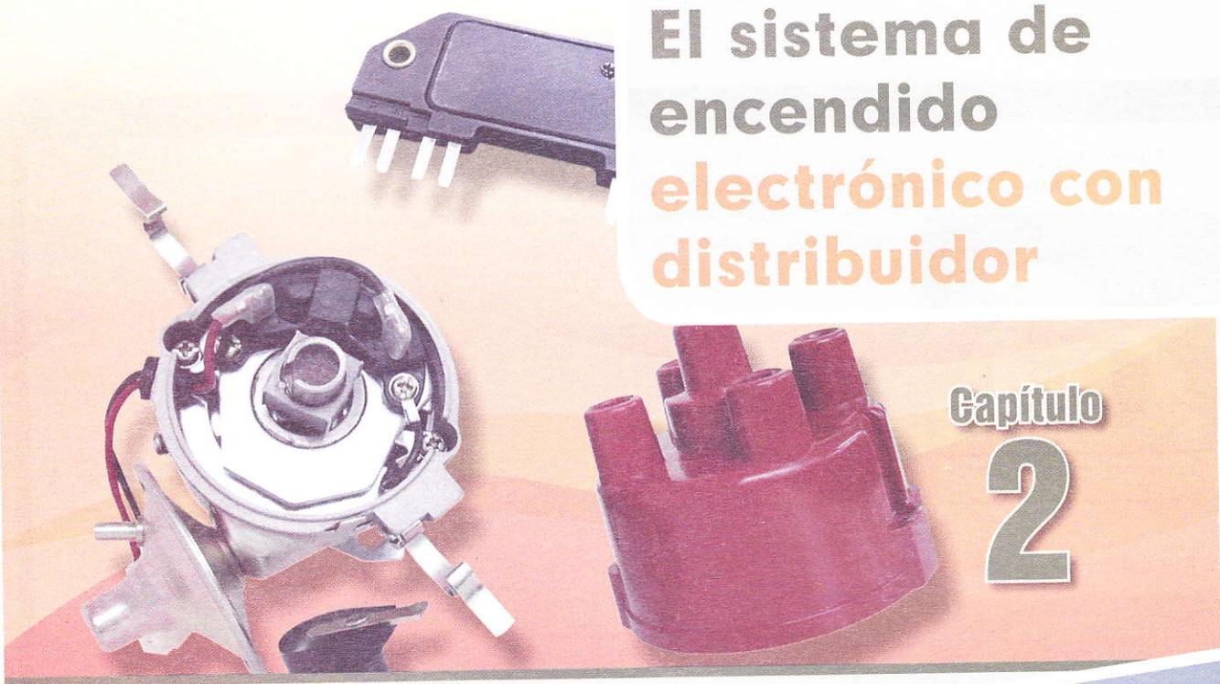
En el sistema de encendido se han incluido elementos electrónicos, para generar la corriente de alta tensión y distribuirla de manera sincronizada entre las bujías. Recordemos que para obtener alto voltaje en la bobina, es necesario que circule una corriente por el circuito primario y luego se interrumpa.
