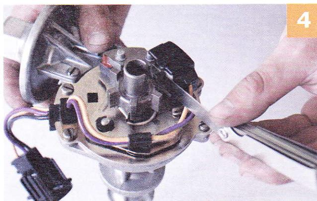
4 Verificar que la bobina captadora (generador de señales) y los dientes del rotor estén a una distancia adecuada (especificada por el fabricante). Esto se hace con una lana de calibración.
