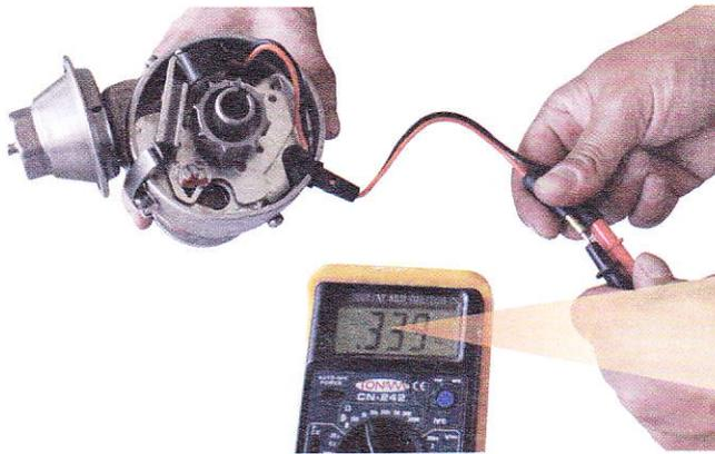
1 Con un multímetro colocado en función de óhmetro, hay que medir la resistencia de la bobina captadora (generador de señales). Debe oscilar entre 400 y 1000 ohmios; de lo contrario, habrá que reemplazar la bobina.
