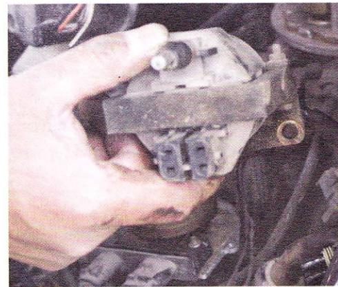
Para desmontar esta bobina, se deben retirar sus tornillos de fijación. Luego hay que extraerla junto con sus cables de conexión, y verificar que no tenga daños; si los tiene, deberá ser reemplazada al igual que su junta de sello.
