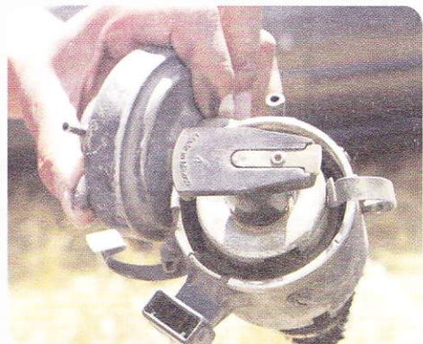
Limpiar los conectores del sensor de efecto Hall. En este caso, se debe utilizar líquido dieléctrico o *Silljet*.
