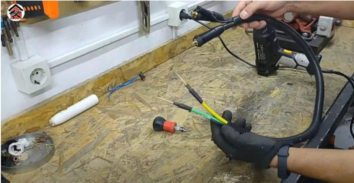
A continuación colocaremos el otro electrodo, pinchando en el mismo cable introduciendo lo con el mismo cable, colocando el tubo termoretractil sera suficiente
