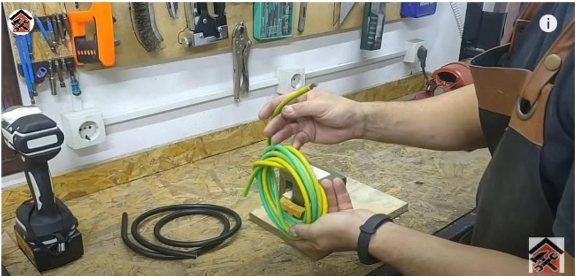
Utilizaremos dos tipos de cables , tomemos uno de 1\* 16 cm de color verde , que sera para el porta electrodo, el negro que es mas grueso y mas fuerte que es de 1\*25 cm , lo vamos a utilizar para darle las dos vueltas al secundario del transformador
