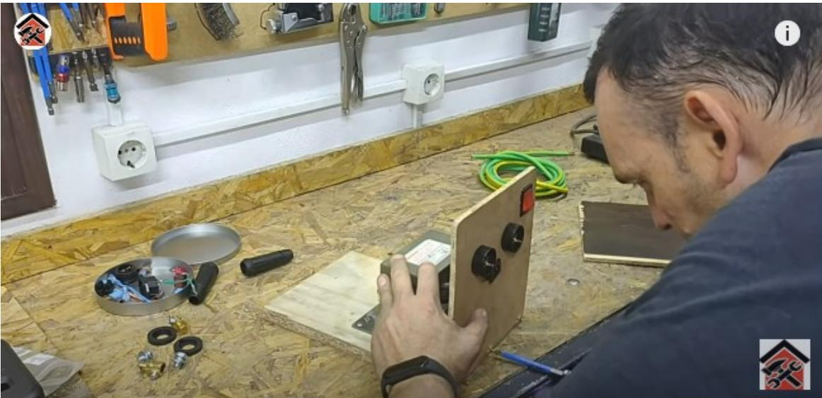
Una vez terminada la parte delantera la fijaremos con unos tornillos, así ir encapsulando nuestro soldador
