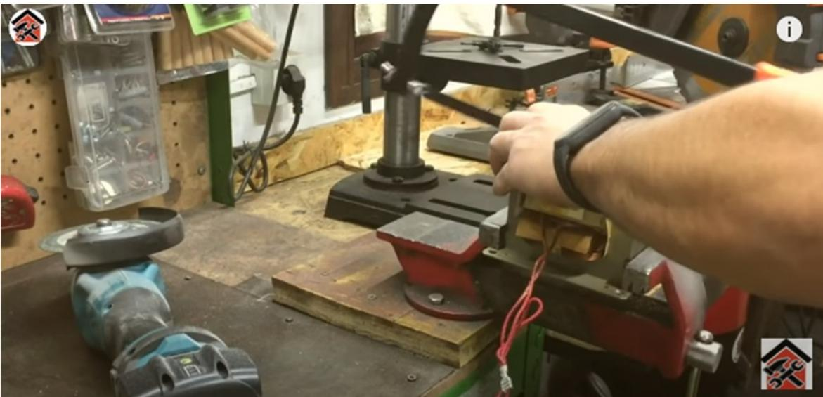
Utilizaremos la segueta para cortar el conductor y poderlo extraer con mayor facilidad
