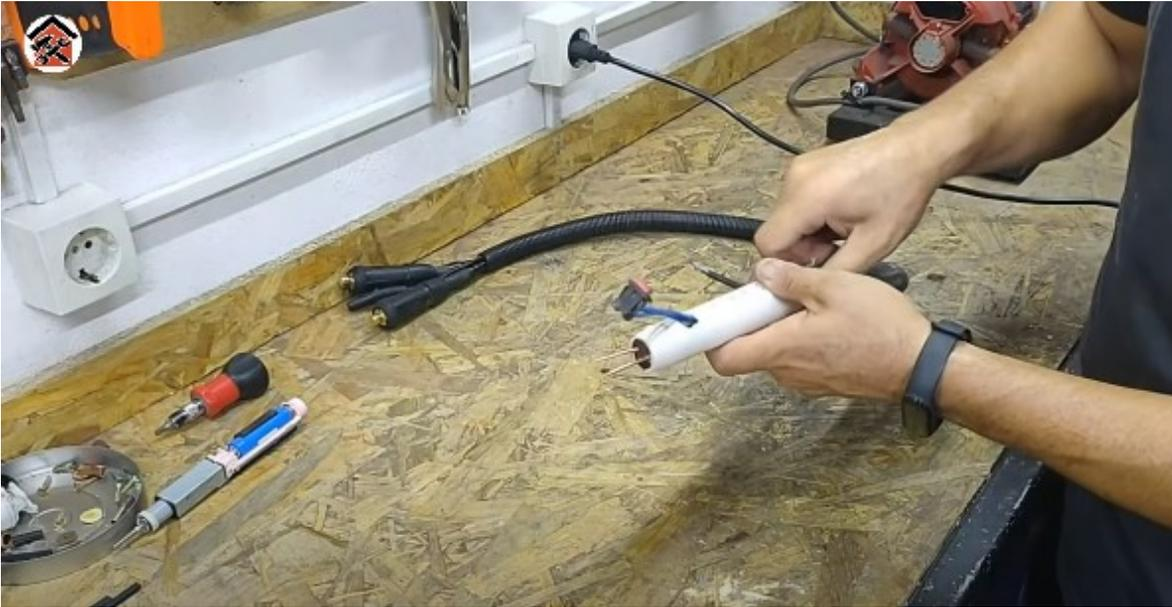
Hemos introducido un trozo de madera en la punta donde saldrán los dos cables , de esta manera quedaran totalmete fijo los eñectodos, introducimos le pulsador
