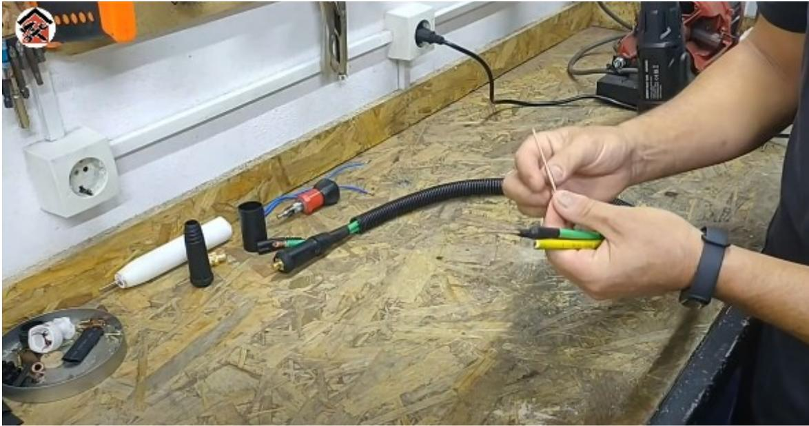
En la punta ya le hemos colocado el electrodo que consiste en una barra de 5 mm de cobre
