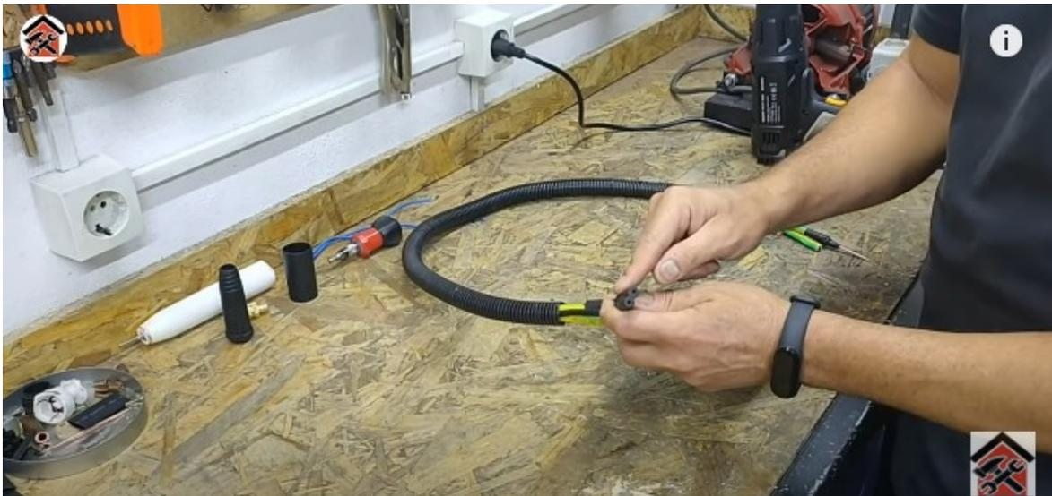
A continuación vamos a conectar los electrodos , como dijimos al principio utilizaremos el cable de 1\*16 cm, en la figura se observa que ya hemos introducido los dos cables por un tubo corrugado , además hemos introducido el cable que nos servirá como pulsador y funcionen los electrodos ,señalamos la clavija de conexión que colocamos en la parte frontal
