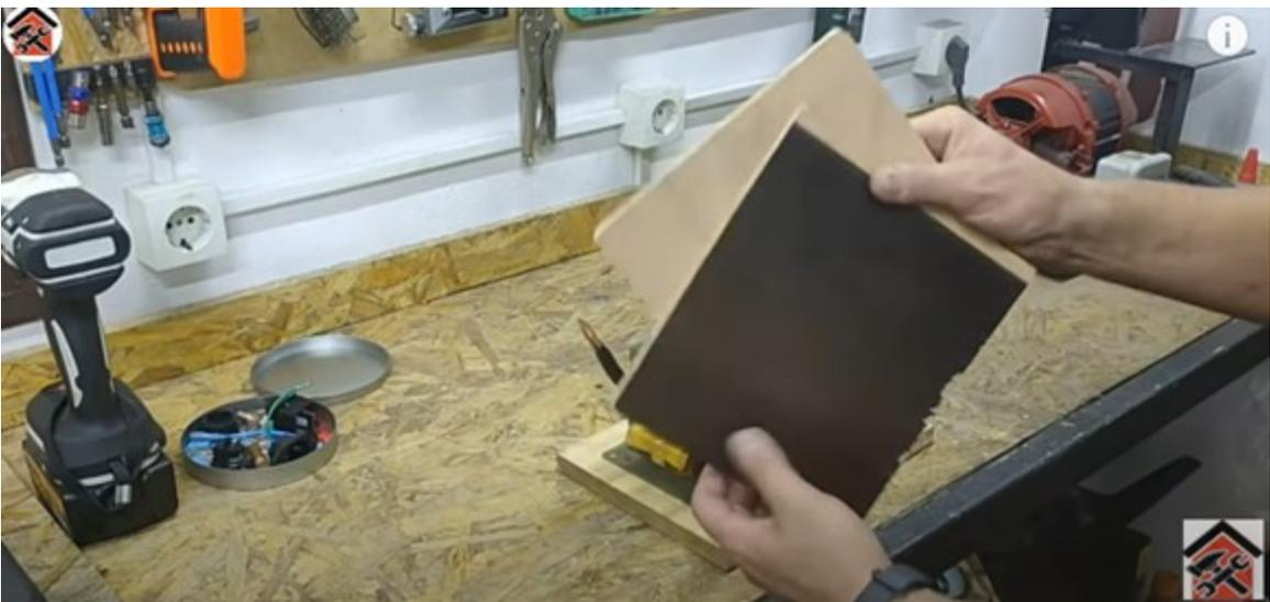
El siguiente paso consiste en colocarle las tapas posterior y trasera , para eso utilizaremos dos trozos de madera las medidas de referencia que se han utilizado son 20 cm de alto \* 18 cm de ancho
