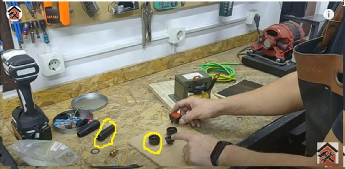
Antes de colocarlo le tenemos que hacer los agujeros de las piezas que se van a colocar, como son el interruptor general, para conectar los cables de los electrodos utilizaremos, conectores que se utilizan para las soldadas eléctricas, queda más estético y se puede desconectar para recogerlo, finalmente para el pulsador de las puntas de electrodo, utilizaremos un conector que se puede conseguir en una radio
