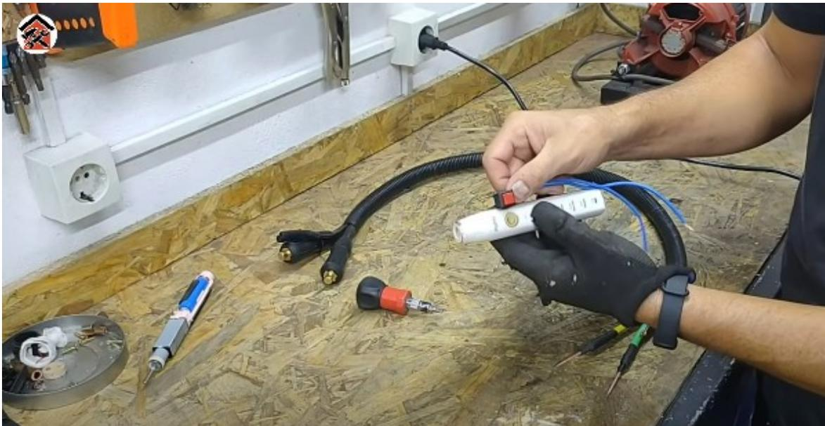
Para que el electrodo no quede suelto, utilizaremos el estuche de un cepillo eléctrico, agradaremos el hueco para colocar el interruptor e introduciremos el cable
