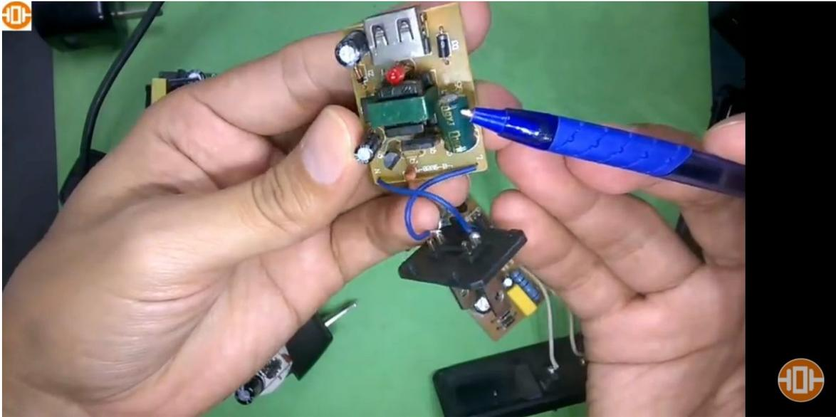
por ultimo serían los diodos los elementos que se pueden dañar.
