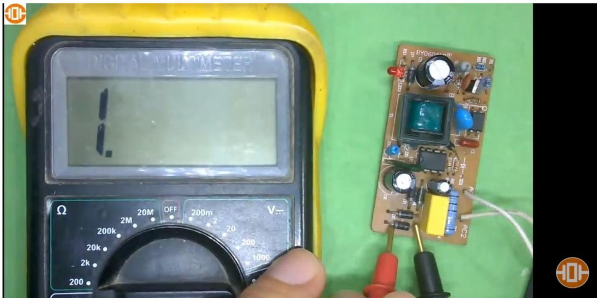
y si se toma las dos puntas de medición de diodo suena como un pitido, eso quiere decir que el diodo está en corto circuito, lo que debemos probar del
