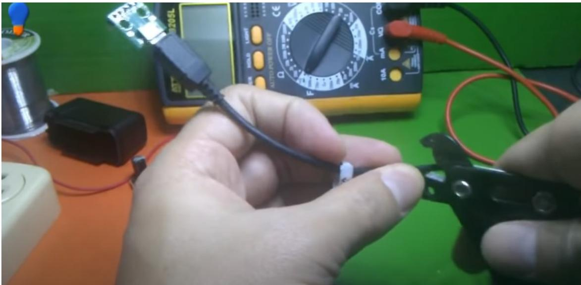
Ya está picado, ahora vamos a verificar si el problema está aquí. Se pela el cable, recuerden que el rojo no tiene el problema, entonces hay que concentrarse en el otro cable. Con el tester se coloca el negativo en el conector, se prende el tester y se coloca el otro caimán en el cablecito, aparentemente aquí está el problema concentrado en la punta.
