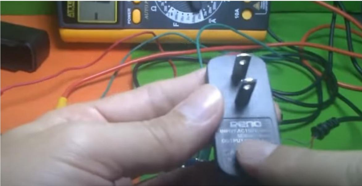
Una vez listos, se enciende la regleta y se toca acá, no se sabe en qué parte del cable está el problema, pero aquí dice que hay voltaje, o sea que está bien y no hay que meterse con la electrónica, solamente tendría que cambiar el cable y se resolvería el problema.
