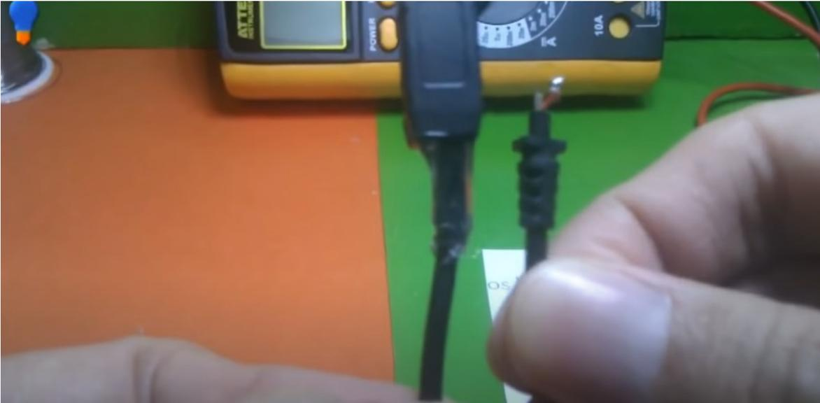
Para este caso que se suelta la tapa de la carcasa, se puede resolver de forma sencilla con cinta plástica enrollando de arriba hacia abajo, dándole varias vueltas.
