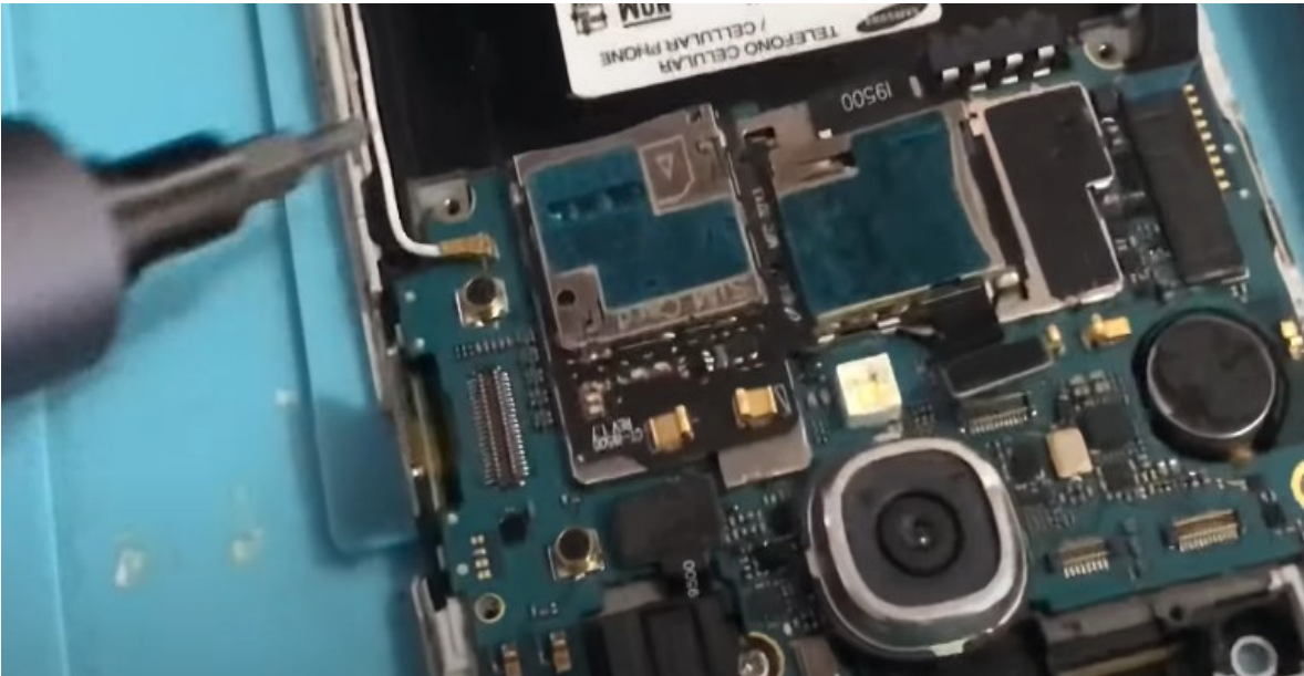
Aquí este cable es el cable coaxial de la antena.
