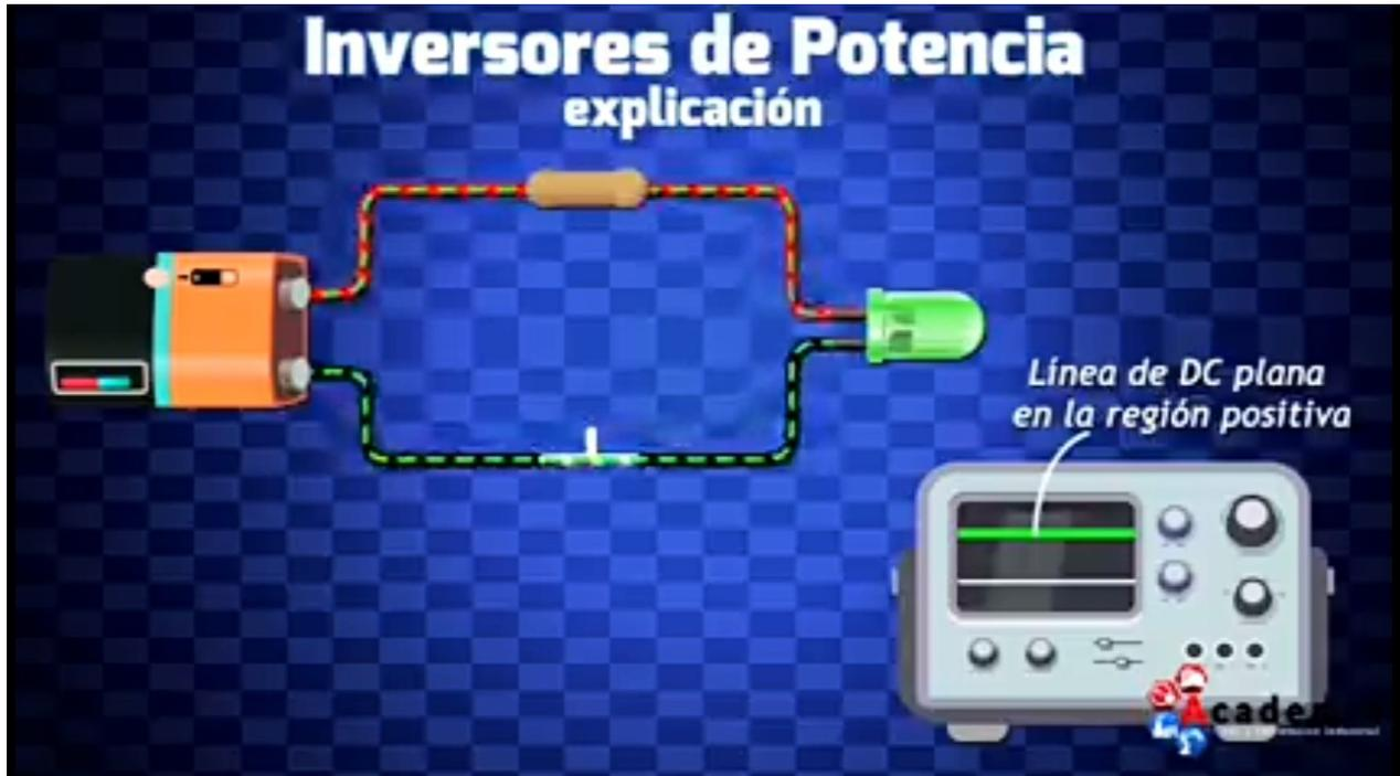
Si tuviéramos que cortar la energía entonces la línea caerá en cero y si encendemos y apagamos la energía repetidamente obtenemos un patrón de onda cuadrada entre el cero y el máximo.
