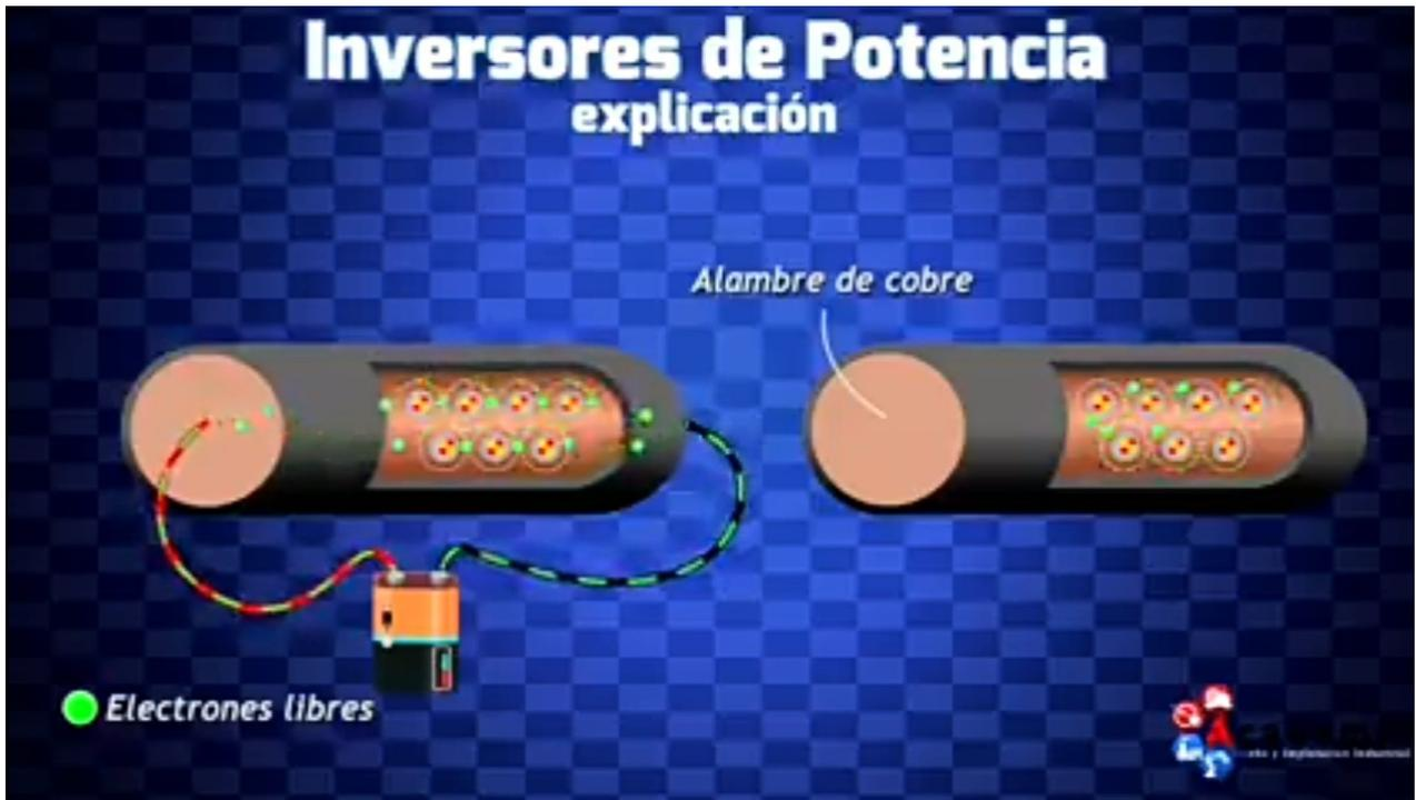
Cuando conectamos un cable a los terminales positivo y negativo de una batería completamos el circuito y los electrones comienzan a fluir; a este flujo de electrones lo llamamos corriente; los electrones siempre intentan volver a su fuente, entonces si colocamos equipos eléctricos como lámparas en el camino de los electrones, tendrán que pasar a través de esto y por lo tanto harán un trabajo para nosotros como iluminar esta lámpara.
