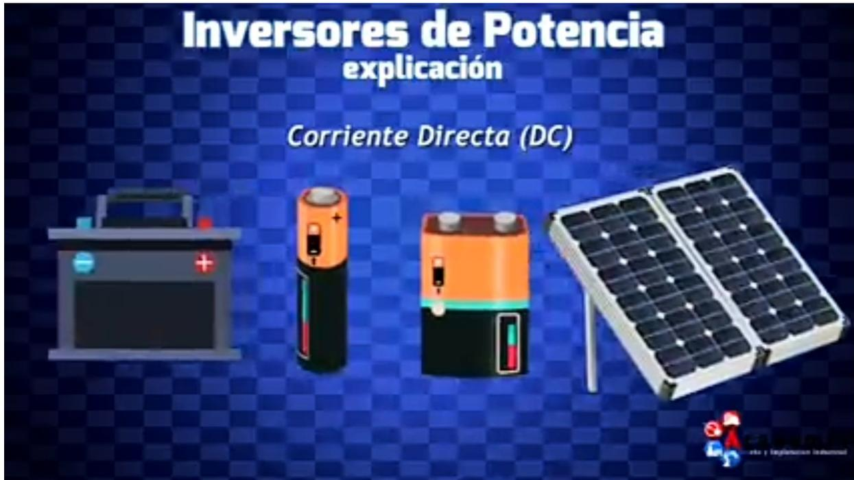
Si invertimos la batería, los electrones fluyen en sentido contrario, siempre mencionamos que puedes imaginar la electricidad de DC como un río con la corriente de agua fluyendo en una sola dirección. Ahora podemos ver el flujo de electrones de positivo a negativo y al invertir la batería también se invierte la dirección del flujo.
