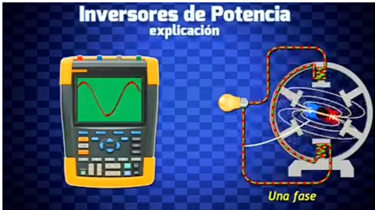
Con electricidad trifásica; tenemos una conexión con cada una de las tres fases, las fases son bobina de alambre que se insertaron en el generador a  $120^\circ$  del anterior, esto significa que las bobinas experimentan el pico del campo magnético giratorio en diferentes momentos y es esto lo que nos da nuestras tres fases cada una con una onda sinusoidal diferente que está ligeramente desincronizada con respecto al anterior.
