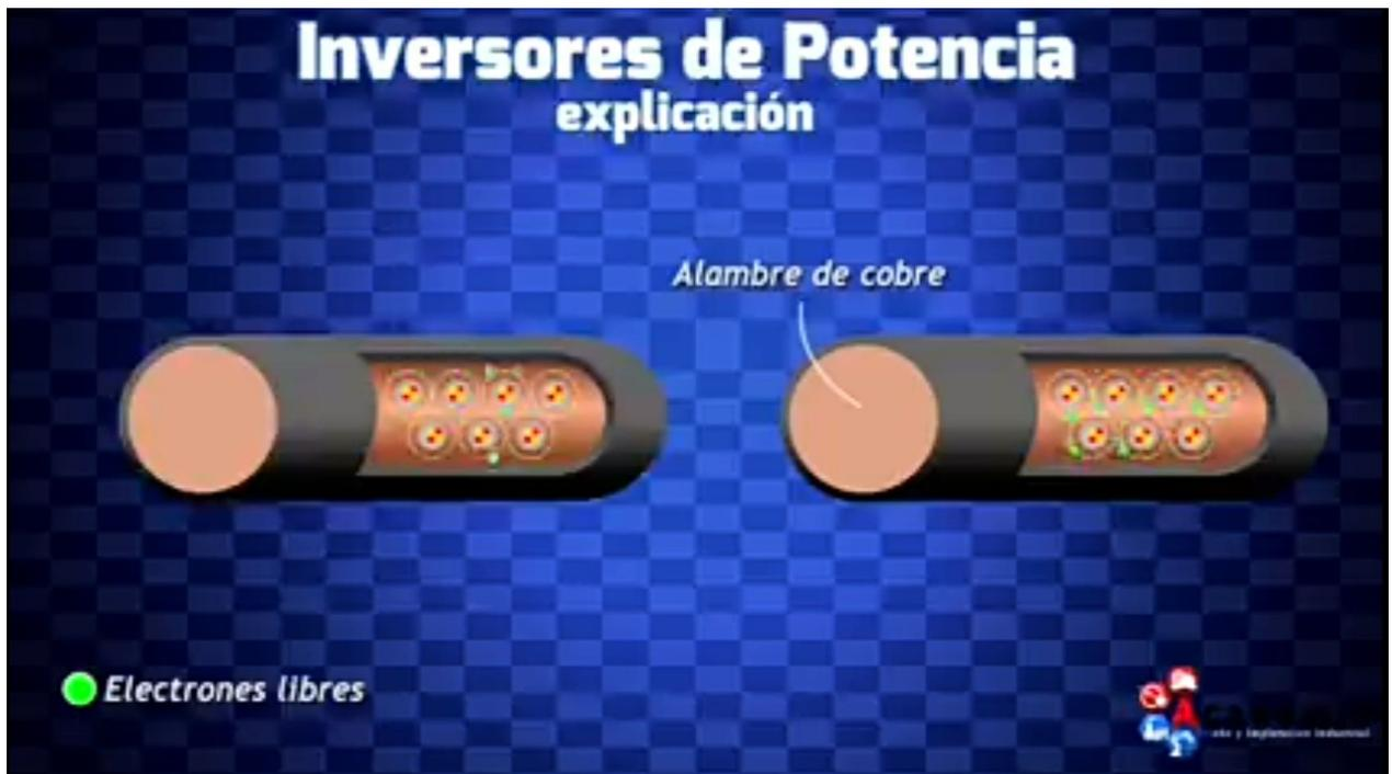
Esto lo podemos realizar aplicando una diferencia de voltaje a través del cable, el voltaje es como la presión y empujaría a los electrones.
