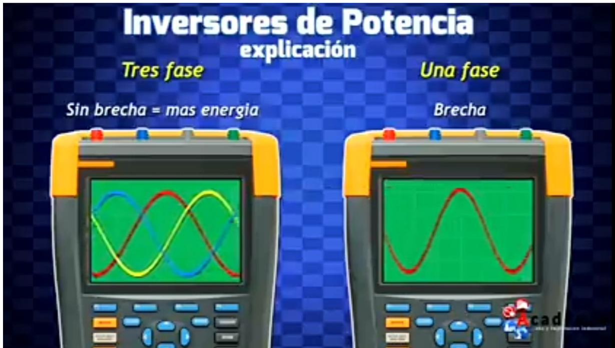
**Inversor de tres fases;** las aplicaciones más grandes requieren un inversor trifásico por ejemplo para hacer funcionar los compresores en un sistema de refrigeración grande.
