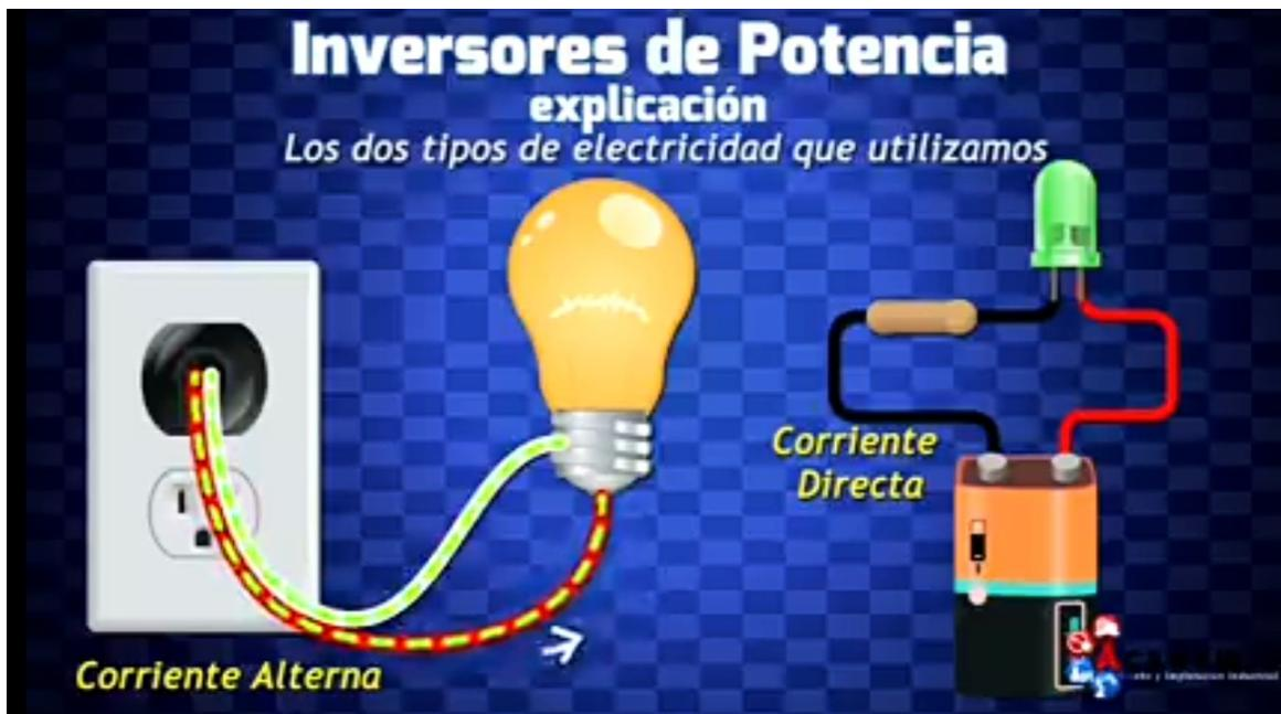
Un inversor se utiliza para convertir corriente continua o DC en corriente alterna o AC.
