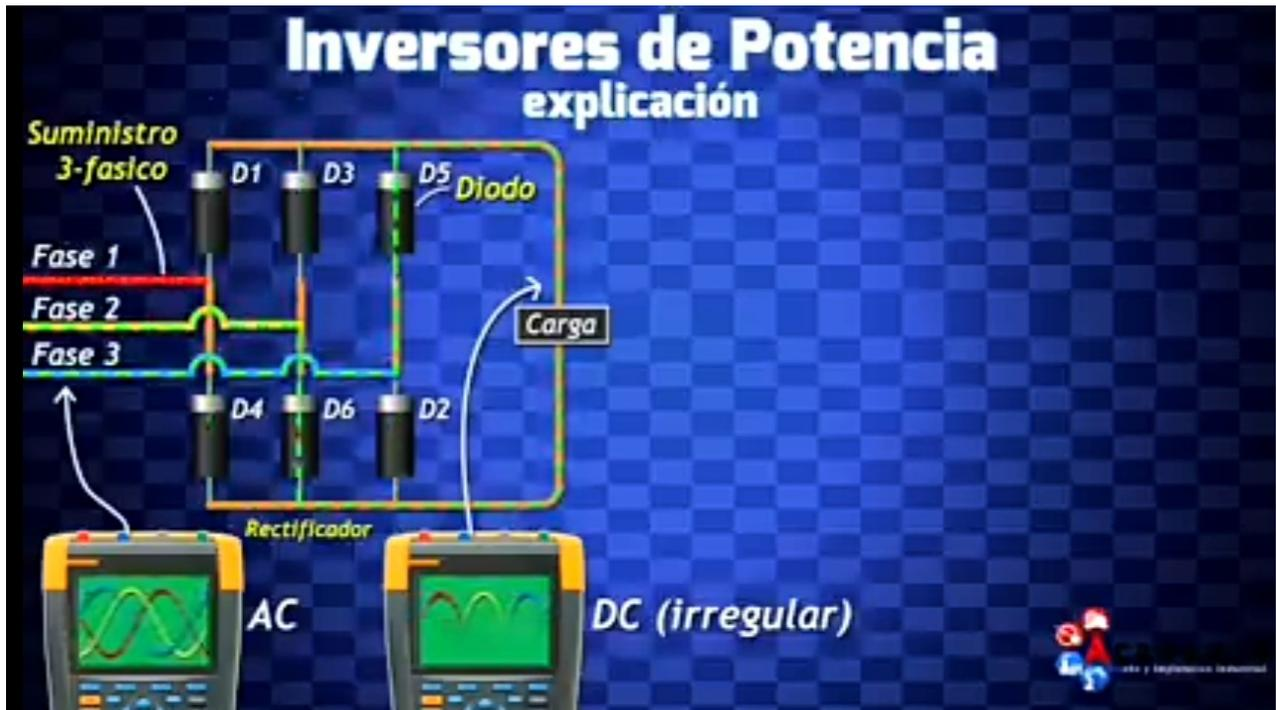
Esto lo convierte en una forma de onda de DC ondulada, luego se usa un capacitor para suavizar la ondulación en un suministro de DC constante.
