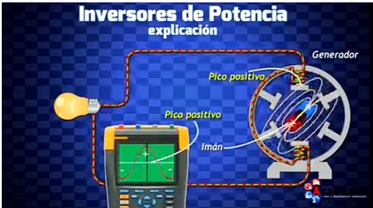
¿Qué es la frecuencia?; la frecuencia se refiere a cuantas veces se repite esta onda sinusoidal de AC por segundo.
