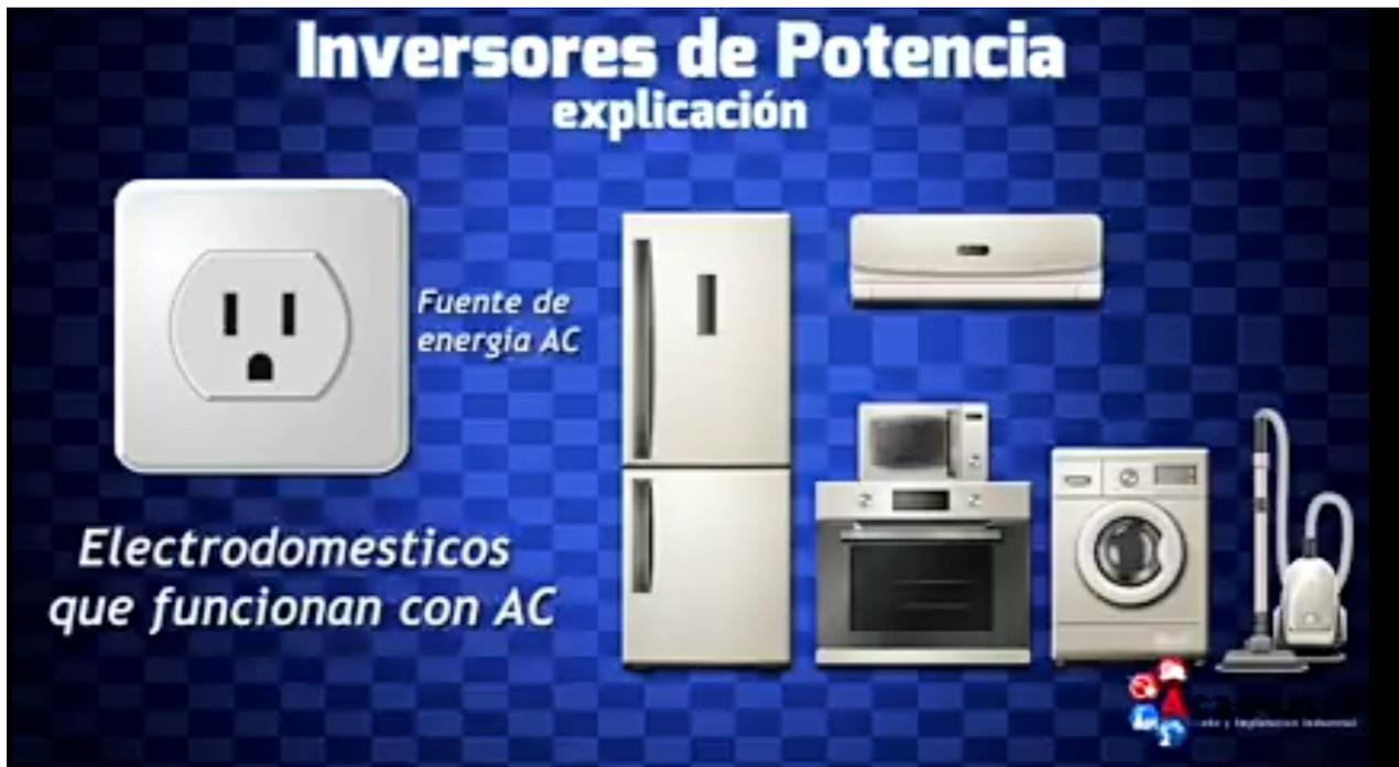
Sin embargo la electricidad producida por elementos como paneles solares y baterías producen electricidad de DC, entonces si queremos alimentar nuestros dispositivos eléctricos a partir de fuentes renovables como bancos de baterías o incluso nuestro automóvil, entonces debemos convertirlas de electricidad DC a electricidad de AC, y se debe hacer con un inversor.
