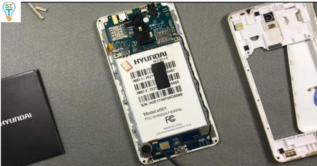
Este es el pin de carga, se tendría que levantar esta placa si se quiere sacar el pin.
