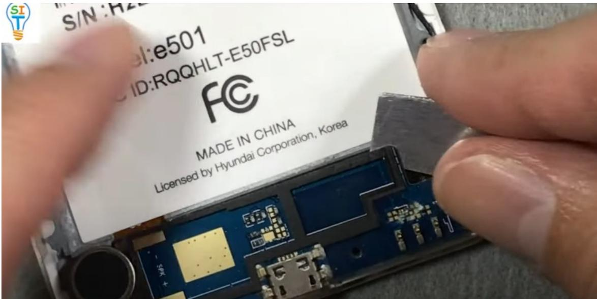
Se levanta el vibrador y se termina de despegar.
