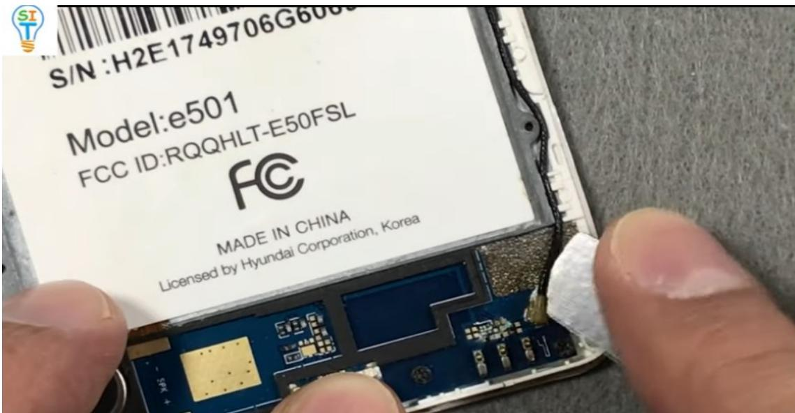
Esta placa se divide en dos partes. La placa de arriba se comunica con la de abajo por un Flex que pasa por debajo.
