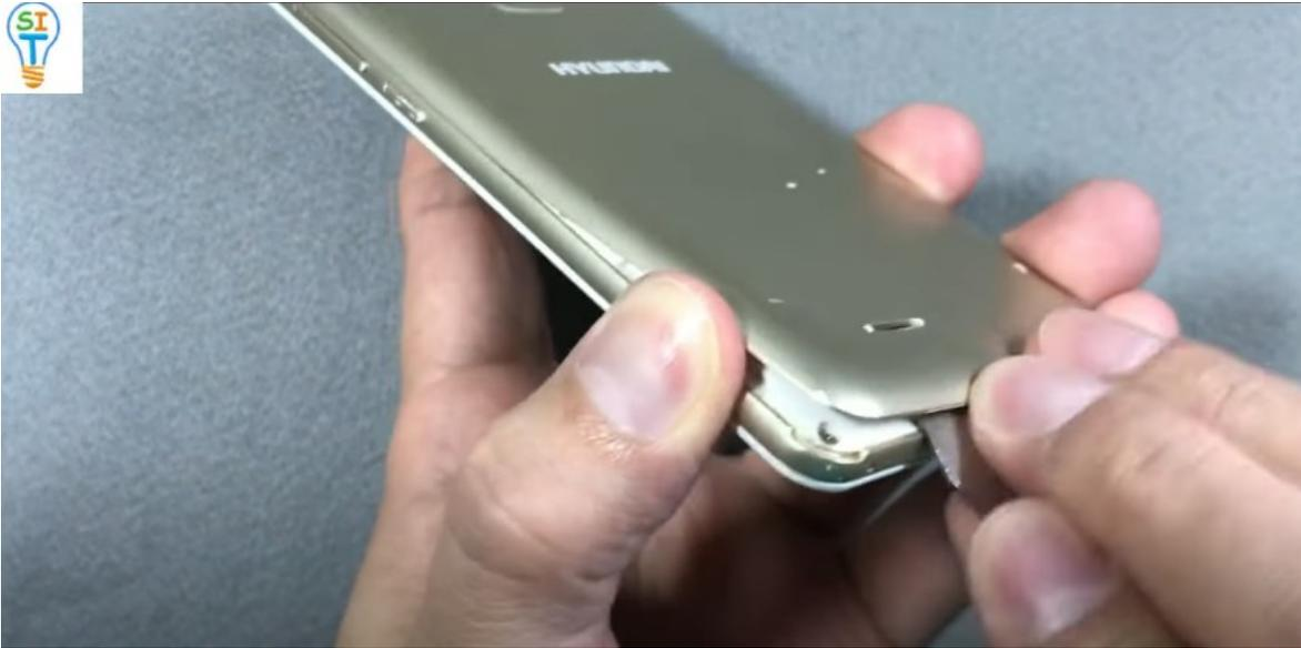
Se saca la batería, aquí también están todos los datos por si acaso desean sustituirla. El voltaje es de 3,7 y el voltaje de carga máximo es de 4,2 la corriente es de de 2200mAh.
