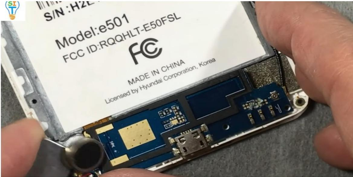
Al levantar la placa fíjense que hay un Flex, este es de la tarjeta del pin de carga, también tiene el vibrador y el micrófono, entre otros elementos más, pero básicamente es del pin de carga.
