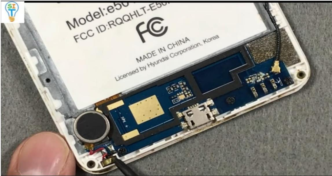
Este es el cable de una de las antenas, se puede levantar fácilmente.
