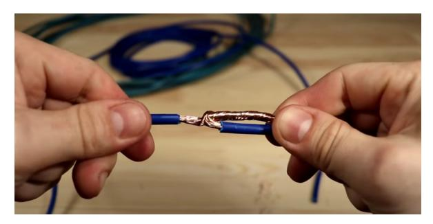
El empalme se gira para uno de los dos lados antes de cubrir con el teipe eléctrico. ¿Cuál sería el resultado si se le aplica fuerza o tensión mecánica?
