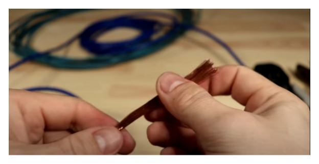
Se limpia el cable cortando las puntas ya usadas.
