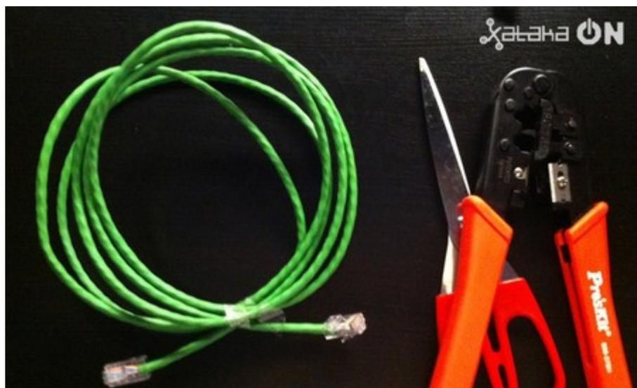
Ya tenemos uno de los extremos. Ahora tendríamos que **repetir el proceso** con el otro y después comprobar que el cable funciona. Si no es el caso, posiblemente hayas tenido algún error a la hora de ordenar los cables por colores o quizás un par no llega hasta los conectores del RJ-45. No pasa nada: siempre puedes cortar la "cabeza defectuosa" y volverlo a intentar.
