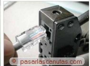
... yo suelo cortar un poco más, unos 14-15 mm., porque al meter los cables dentro del conector la camisa se desplaza un poco ...
