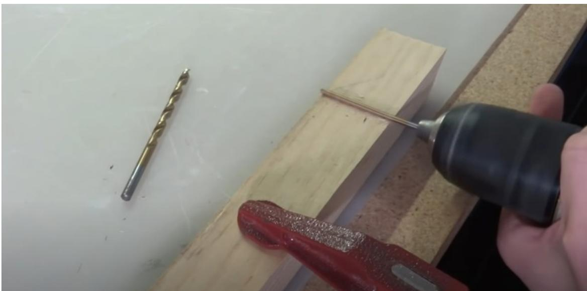
Bien, básicamente lo que se quiere hacer es el canal lo suficientemente profundo para que cuando el cable se coloque este en la parte superior encaje algo profundo y holgado.
