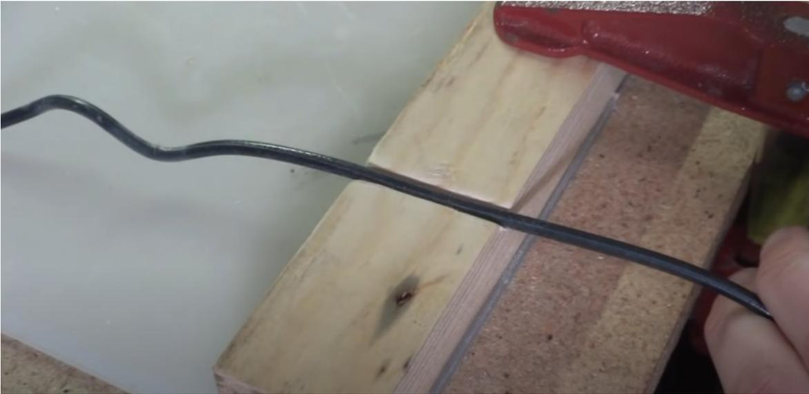
Luego tomar una de las cuchillas de afeitado, colocarlo derecho y su cable puede hacerse a trav s de all , as  como se muestra en la imagen.
