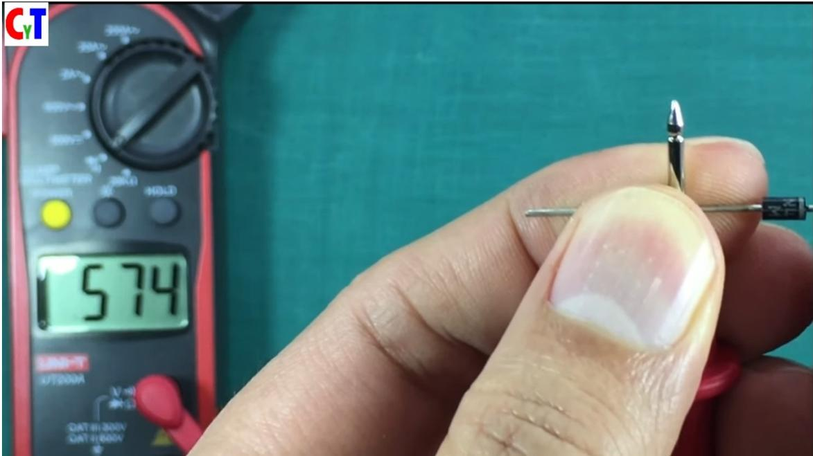
También podemos probar diodos entonces colocamos el cable rojo por un lado y el negro por la franja gris, observamos el multímetro y nos marca un valor de 574 que es el valor del momento, ese es el voltaje de polarización del diodo.
