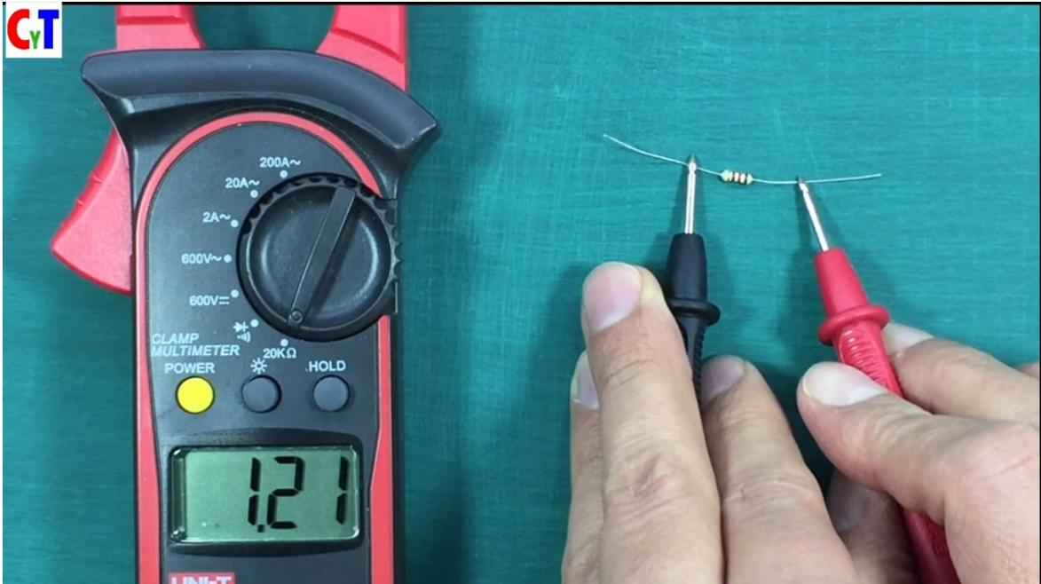
Ejemplo con una resistencia de 1.2 Kilo-ohmios sería el valor de resistencia, medimos y nos marca 1.21 recuerden que como ahí dice 20 K $\Omega$  se debe multiplicar por 1000 entonces sería 1.2 por 1000.
