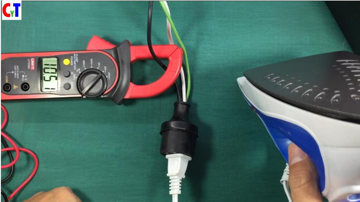
Por ultimo podemos hacer la medición de fuga de corriente por ejemplo si paso tanto el neutro como la fase ósea los cables por la pinza me debería marcar cero
