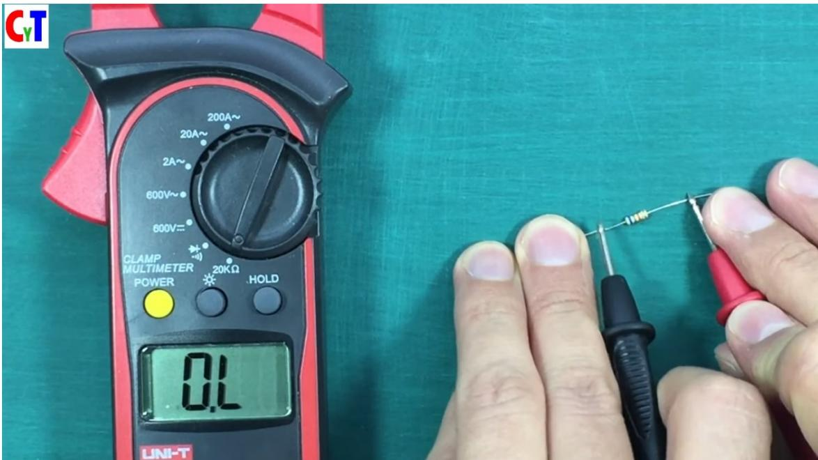
Este caso es de 68 kilo cuando nos va a medir, se pasa y no mide nada ya que el rango se salió entonces esa es la escala de ohmios que tiene este multímetro.
