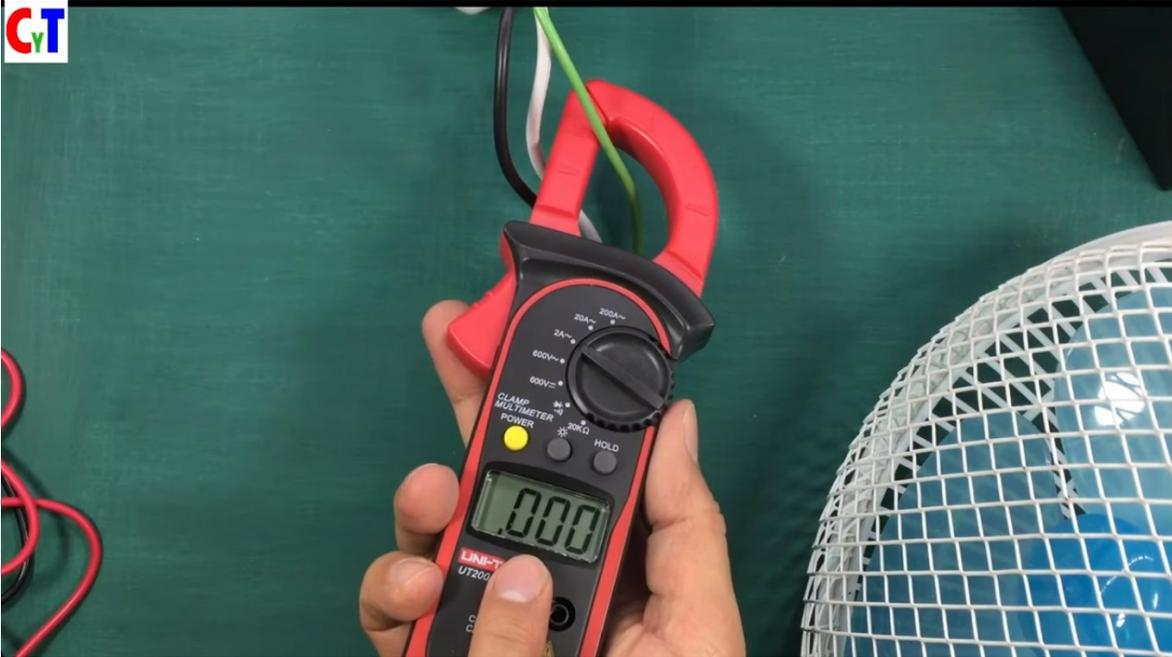
para los aparatos que tienen este cable, si por este cable circula corriente quiere decir que tiene una fuga de corriente.
