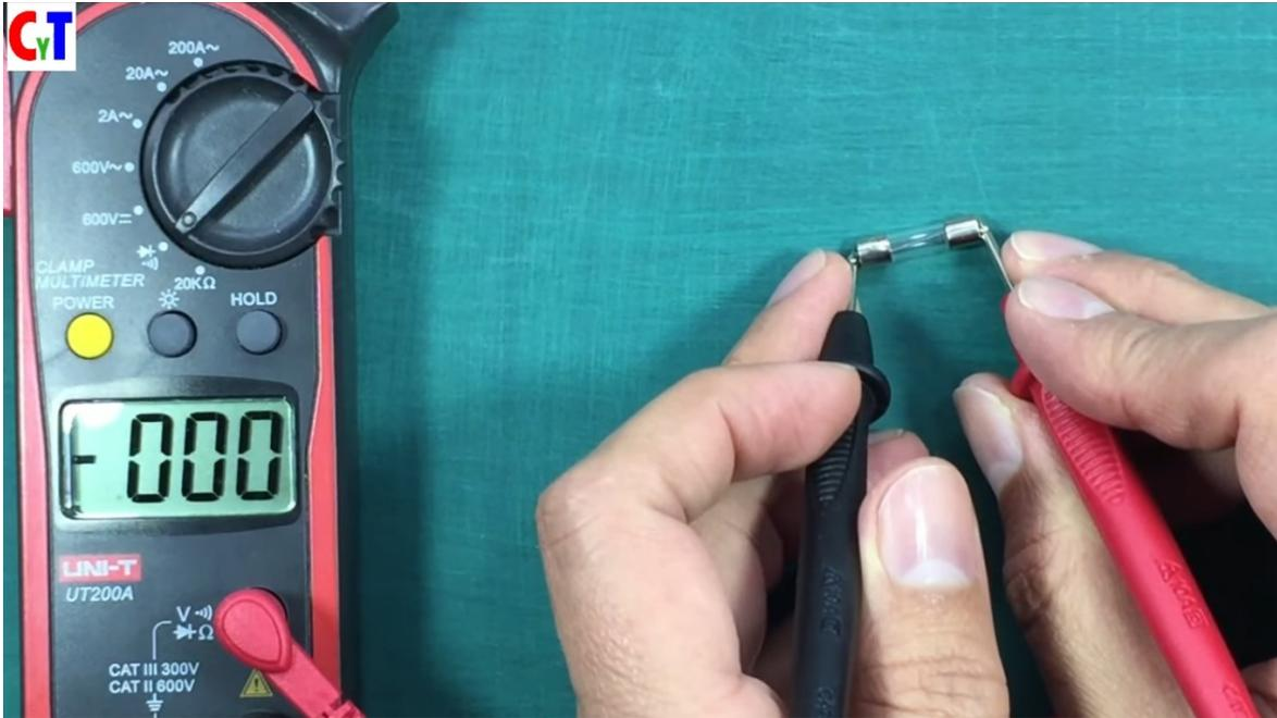
Si probamos un fusible de un equipo electrónico y quieren saber si está funcionando puedes probar en esa escala simplemente con el sonido sabemos que el fusible esta bueno porque hace un corto.
