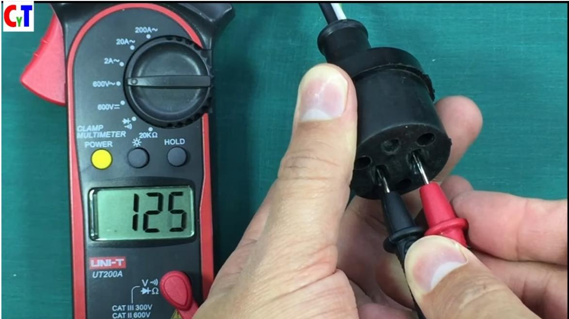
Entonces vamos a ver cuánto nos mide el tomacorriente y nos debería marcar entre 120 a 125 voltios, si lo invierto me mide igual recuerden que en corriente alterna no importa la polaridad, entonces funciona muy bien la escala de voltaje de AC.
