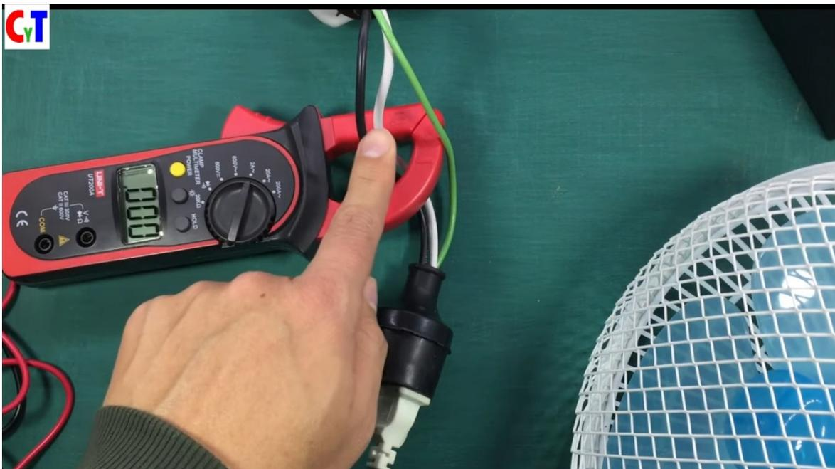
Si me marca diferente de cero quiere decir que la corriente que está entrando por la fase no se está devolviendo por el neutro y me marcara una diferencia de corriente y de esa forma nosotros podremos detectar fuga de corriente colocándolo en la escala o rango más bajo.
