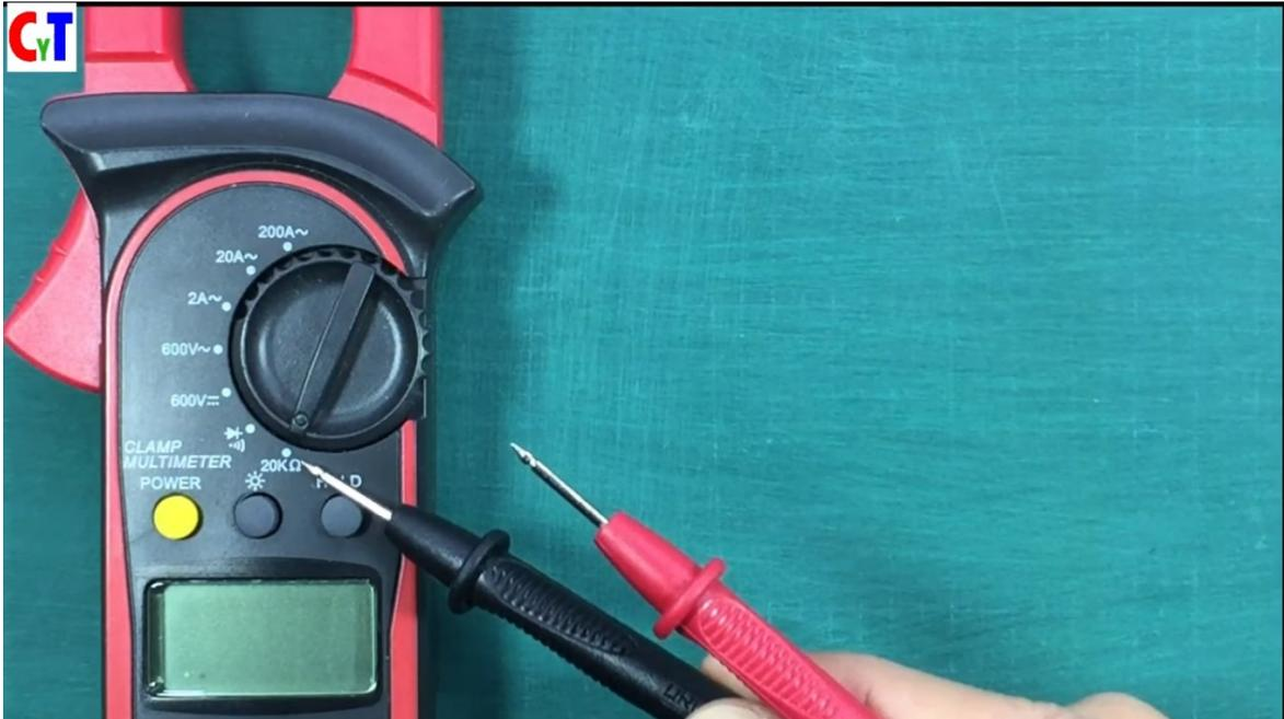
Es el mayor rango o el único rango que tiene este multímetro, quiere decir que puede medir resistencias hasta 20 kilo-ohmios que no pasen de 20 $\Omega$  ya que si pasa simplemente no las puede medir.
