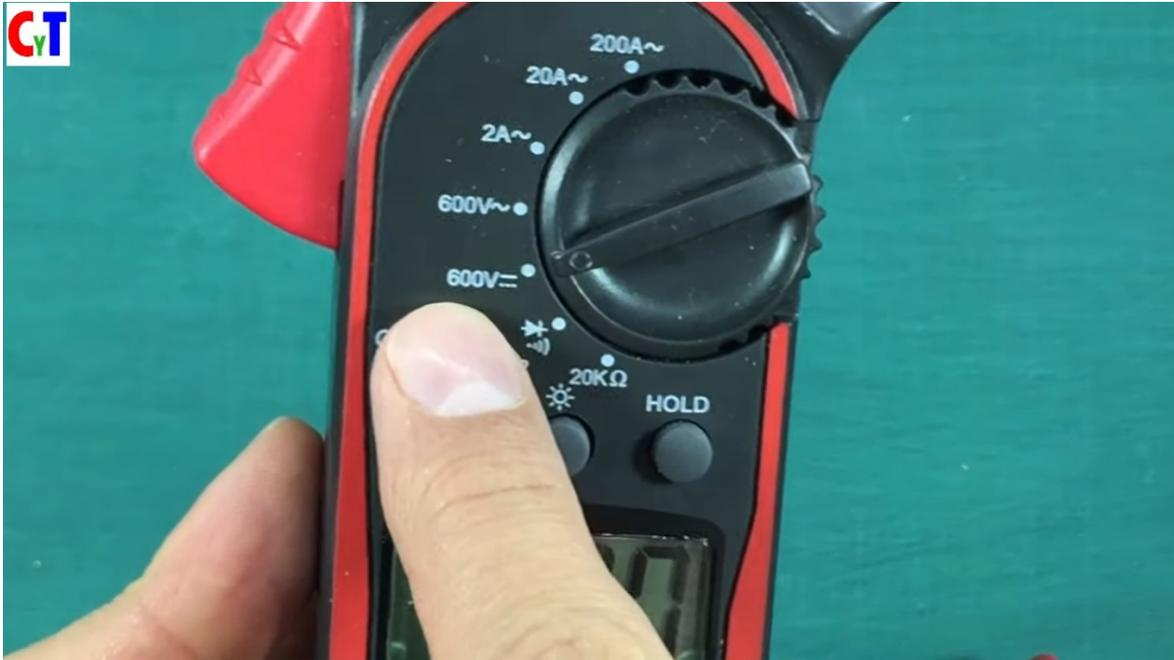
Ahora seguimos con la parte de voltaje de corriente directa entonces 600 voltios significa que puede medir hasta 600 voltios en corriente directa.
