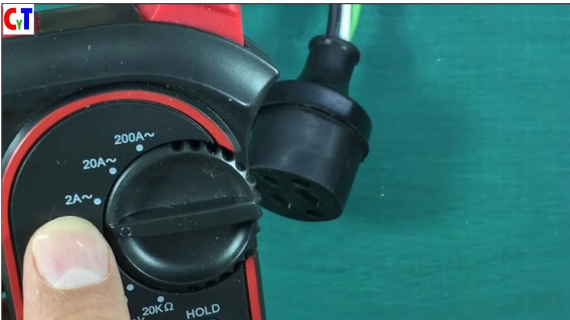
Luego pasamos a medición de corriente que tiene tres rangos o escalas porque están separados sería 2 amperios, 20 amperios y 200 amperios entonces para medir esta corriente alterna no necesitamos los conectores o
