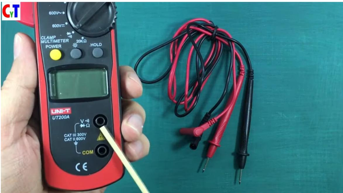
Este amperímetro trae dos puntas la de color rojo en la parte superior y el común que sería el cable negro en la parte de abajo.
