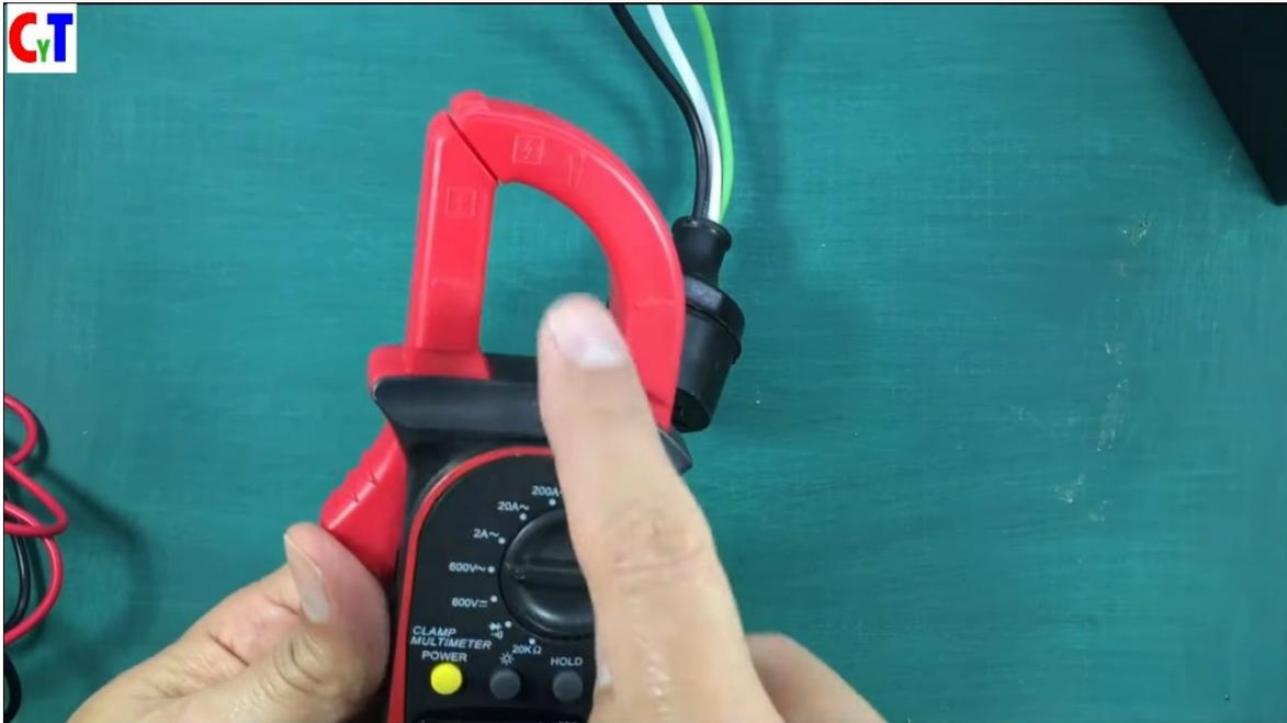
Ejemplo queremos medir la corriente de un pequeño ventilador, entonces lo vamos a conectar al tomacorriente y lo prendemos para poder medir la corriente vamos a colocar el gancho sobre el cable negro y seleccionamos 20 Amperios
