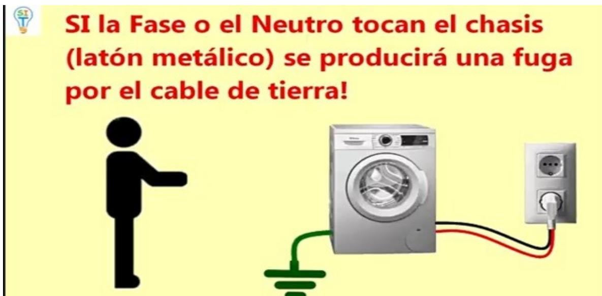
Lo que se debe hacer es verificar todos los equipos que tienen un cable de tierra que no exista una fuga por ese cable.
