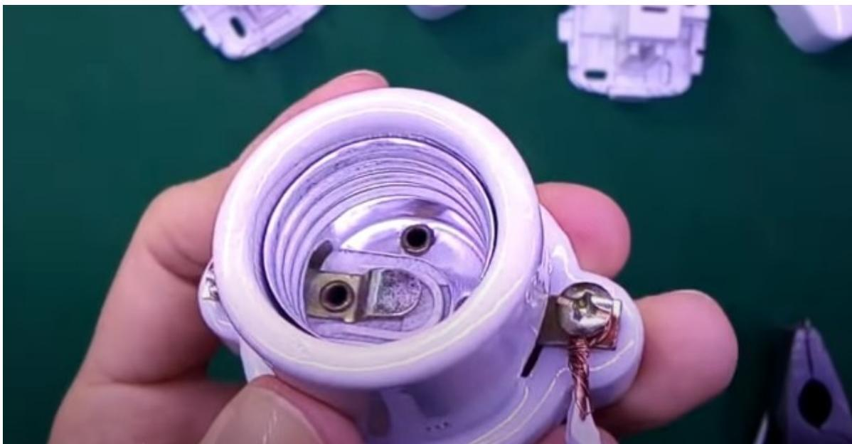
**En el caso de los interruptores o tomacorrientes que se prensan de esta forma, se debe aflojar el tornillo por donde se va introducir el cable.**
