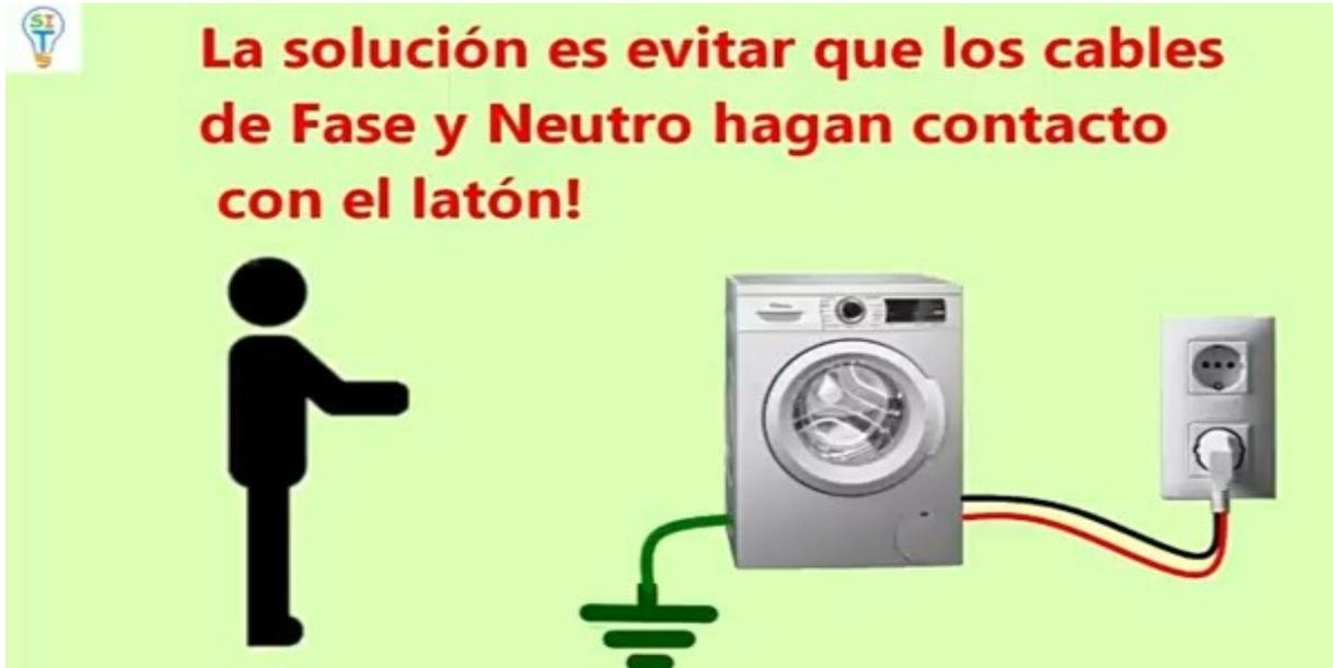
Aquí se muestra un esquema para que vean como sería el consumo de un aparato que está utilizando el cable de tierra.
